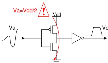
**Figure II.15:** Interfaçage entre analogique et numérique. Un chemin de conduction apparaît si la tension analogique reste à un potentiel permettant la conduction simultanée des transistors de la porte numérique, ici un inverseur.
