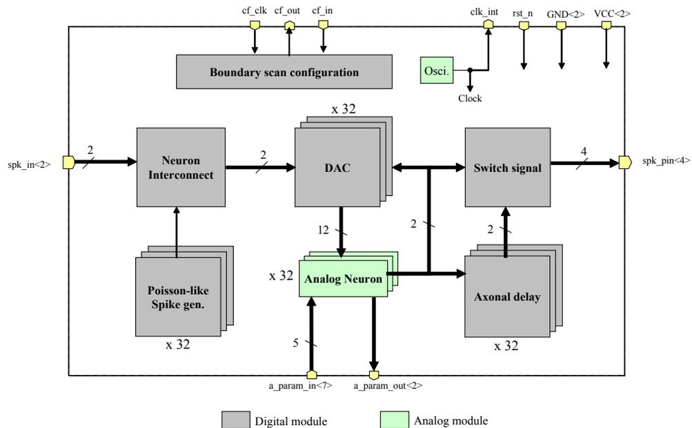
Figure II.27: Architecture du premier circuit de test *Reptile*
