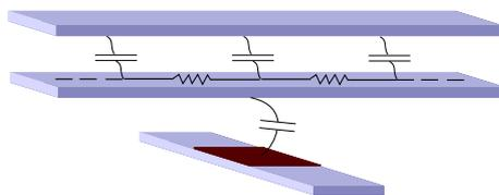
**Figure II.3:** Phénomènes de couplage pouvant exister lors de la réalisation physique d'un circuit. On montre ici un cas classique : la formation d'une capacité parasite lorsque deux fils se superposent ou se croisent.
