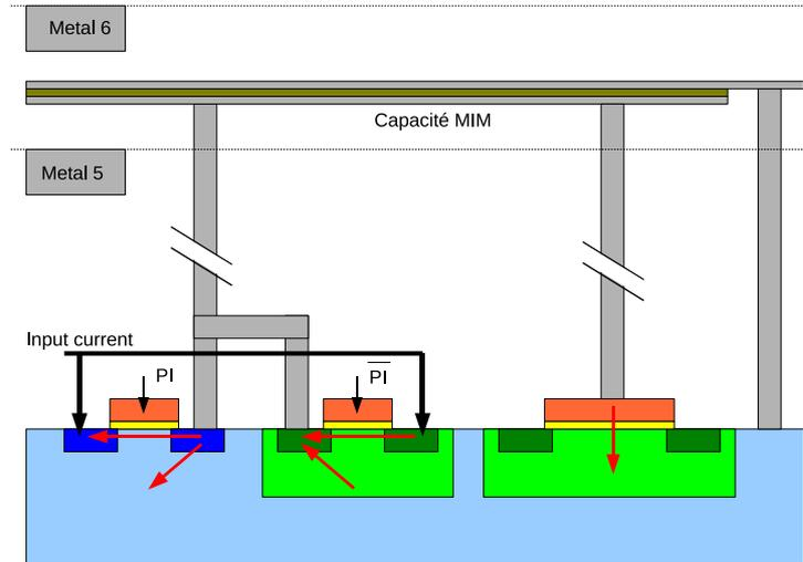
**Figure II.17:** Schéma des différents courants de fuites aux bornes de la capacité : à gauche l'interrupteur commandé par le signal PI (pulsed injections), à droite le PMOS à l'entrée du comparateur. On peut y identifier les 3 types de fuite : a) courant de la jonction de diode polarisé en inverse, b) courant de diffusion dans le canal, c) courant de grille.
