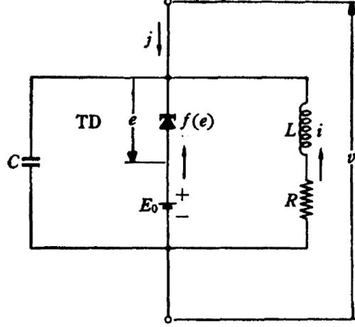
**Figure I.7:** Schéma électronique équivalent du modèle de Fitzhugh et implémenté par Nagumo dans (59).
