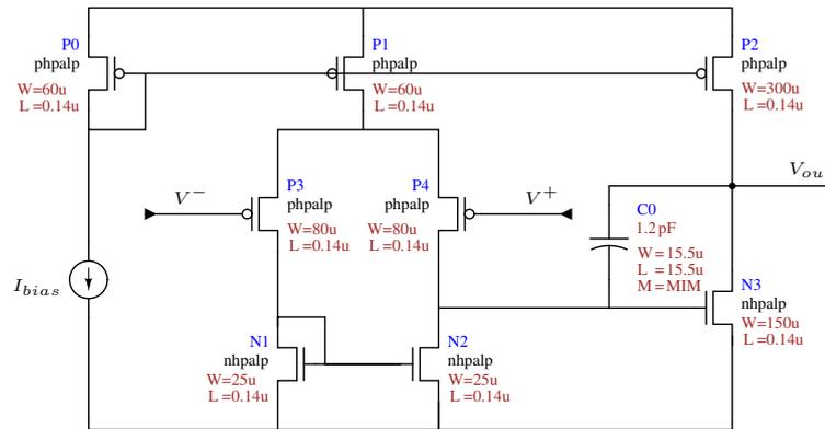
**Figure II.29:** Schéma de l'amplificateur pour l'observation du potentiel de membrane. Il est connecté en suiveur dans les circuits *Reptile* et *Spider*.  $I_{bias}$  est de l'ordre du mA (0.9 à 1.1 mA) et polarise les transistors de l'amplificateur à l'aide d'un générateur externe.
