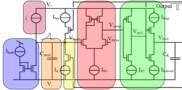
**Figure II.5:** Schéma d'un neurone d'après *Van Schaik* (85).
