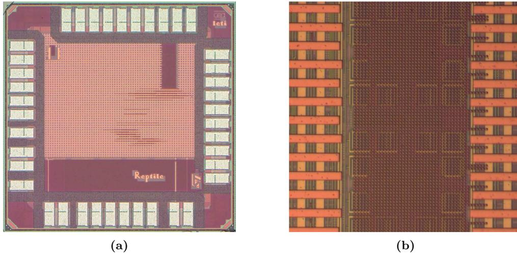
**Figure II.30:** Photographies du circuit *Reptile* : (a) Vue globale, cœur du circuit et couronne de plots (taille 1mm × 1mm). (b) Zoom sur les neurones. On observe les tuiles générées pour la densité au niveau du métal 7 ainsi que le métal 6 d'accès aux capacités MIM.
