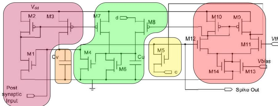
Figure II.7: Schéma d'un neurone d'après Wijekoon (87).
