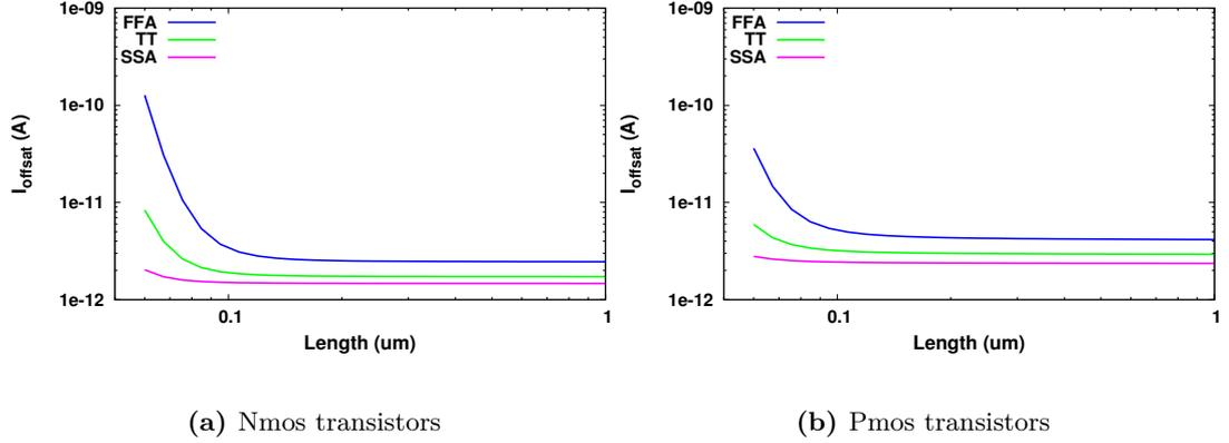
**Figure II.14:**  $I_{offsat}$  de transistors MOS de type HVTLP en fonction de leur longueur de grille pour différents corners : TT, FFA, SSA.  $V_{gs} = 0 V$ ,  $V_{ds} = 1,2V$ ,  $W = 1 \mu m$  et  $T = 27^\circ C$
