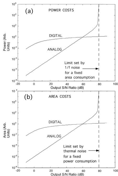
**Figure II.4:** Analogique et numérique. Figure (a) : Considération énergétique. La limite analogique est fixée par un bruit en  $1/f$ . Figure (b) : Considération surfacique. La limite est alors contrainte par le bruit thermique (71)
