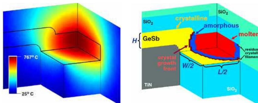
Figure III.6: Fonctionnement thermique d'une PCM. Figures d'après (31).
