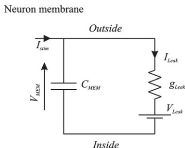
**Figure I.6:** Schéma électronique équivalent du modèle LIF d'après (66) : les milieux intra et extracellulaires sont séparés par la capacité et reliés par un courant de fuite. On notera cependant l'absence de remise au potentiel de repos  $V_{rest}$  sur ce schéma.
