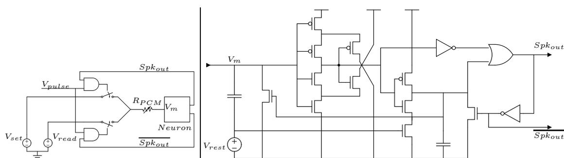
**Figure III.15:** Schéma de test du neurone couplé à une PCM et son propre schéma. Il permet la diminution de la résistance d'une PCM lorsqu'il y a corrélation entre les impulsions présynaptique et postsynaptique.
