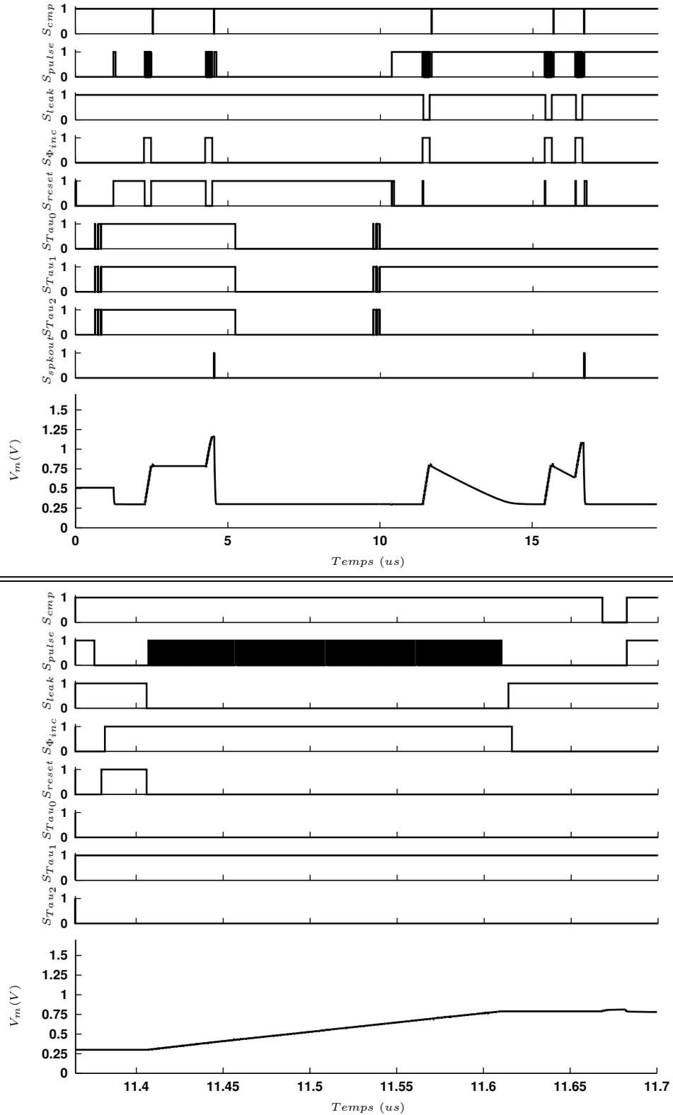
**Figure II.20:** Chronogramme des signaux de contrôle du DAC lors de l'évolution du potentiel de membrane  $V_m$ . En haut : Le neurone est configuré en mode IF puis après reconfiguration en mode LIF ; les poids sont égaux à  $+0.8$ . En bas : zoom lors de l'injection d'une impulsion en mode LIF.
