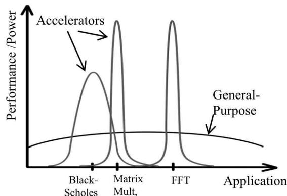
**Figure I.13:** En visant une application, un accélérateur matériel accroît ses performances énergétiques. D’après (89).
