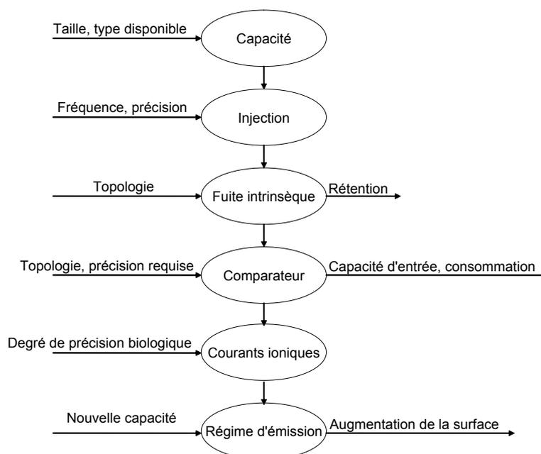
**Figure II.11:** Méthodologie adoptée pour la conception du neurone. Dans le contexte du projet Arch<sup>2</sup>Neu, l'avant dernière étape se résume à une remise au potentiel de repos et à une fuite simple (constante et programmable). Quant à la dernière étape, elle ne nous est pas nécessaire pour notre implémentation.
