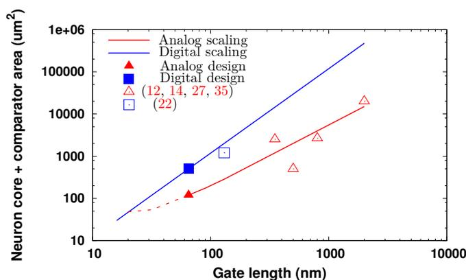
**Figure III.2:** Passage à l'échelle de neurones LIF : évolution des implémentations analogiques et numériques selon le nœud technologique. Un croisement relativement proche existe et semble se situer autour du nœud 22 nm.
