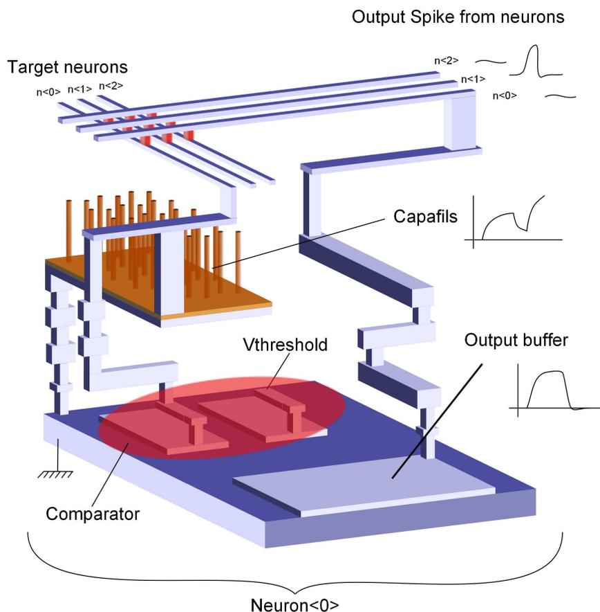
**Figure III.8:** Concept d'implémentation d'un futur neurone analogique. Les synapses sont réalisées par des dispositifs résistifs au niveau du back-end (en rouge). La taille de la capacité deviendra alors une contrainte forte pouvant être réduite par l'intégration de dispositifs à nanofils. Seuls les transistors de comparaison et d'amplification restent sur silicium.
