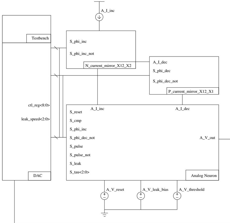
Figure II.21: Banc de test mixte pour neurone analogique.
