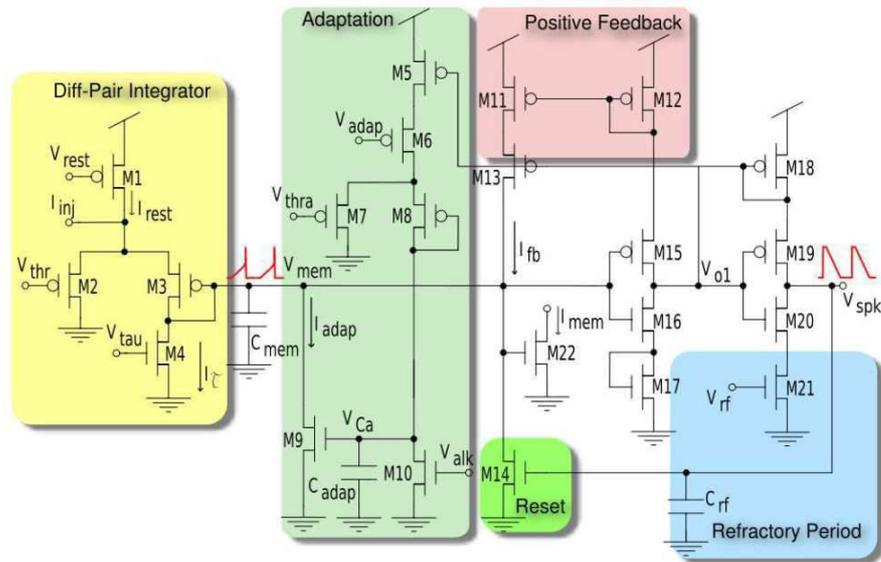
**Figure II.8:** Schéma d'un neurone d'après *Livi* (49).
