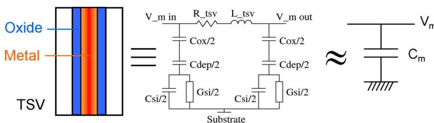
Figure III.9: Structure du TSV et modèle équivalent employé.
