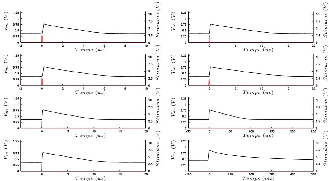
**Figure II.35:** Fuite programmable du neurone après augmentation du potentiel causé par une impulsion et un poids égal à +0.8. Elle est présentée de la plus à la moins importante de haut en bas et de gauche à droite. Causé par l'échantillonnage de l'oscilloscope, le potentiel d'action entrant disparaît pour des temps d'acquisition trop longs.
