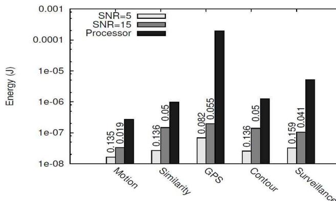
**Figure IV.3:** Comparaison de l'énergie consommée par un processeur et par une architecture neuromorphique basée sur la tuile du circuit *Spider*. Dans ce dernier cas, la détermination du rapport signal à bruit permet d'optimiser la consommation.
