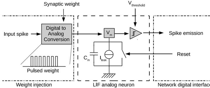
**Figure II.13:** Schéma bloc du neurone analogique LIF, le mécanisme de modulation du poids est réalisé par une conversion en nombre d'impulsions : 128 impulsions correspondent à un poids dont la valeur absolue est égale à 1.
