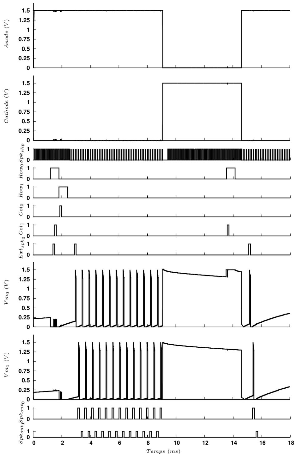
**Figure III.19:** Chronogramme des signaux de contrôle et de sortie des neurones : programmation des CBRAMS, fonctionnement en oscillateur, remise à zéro d'une CBRAM, transmission du PA du neurone 0 au neurone 1
