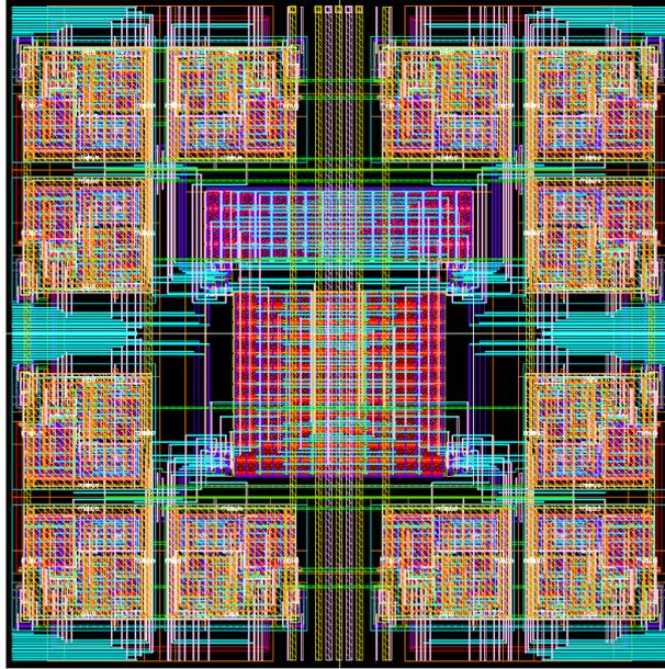
Figure II.26: Layout d'une tuile comportant 12 neurones.
