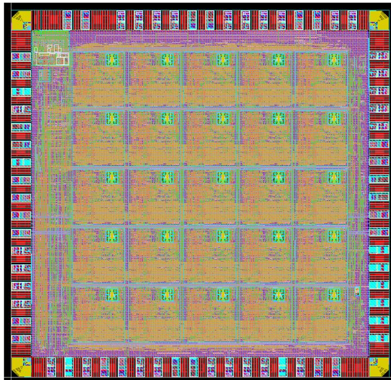
**Figure II.37:** Layout du deuxième circuit réalisé *Spider*. On distingue : la matrice de 5\*5 modules mixtes analogiques/numériques, la couronne de plots, une cellule de compensation requise pour adapter leur fonctionnement post-fabrication. D'autres blocs comme les générateur de Poisson et les blocs de délai sont situés en périphérie.
