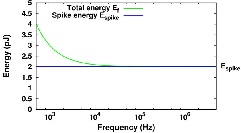
**Figure II.24:**  $E_f$  correspond à l'énergie dissipée pour la génération de potentiels d'action à une fréquence  $f$ . Elle inclue l'énergie nécessaire à l'émission du potentiel d'action (puissance active fonction de la fréquence) et la puissance statique. A partir de  $f = 50 \text{ kHz}$ , la dissipation d'énergie causée par les courants de fuite est négligeable pour considérer  $E_f = E_{spike}$
