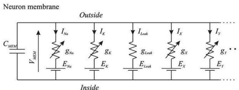
**Figure I.5:** Schéma électronique équivalent du modèle d'Hodgkin-Huxley d'après (66). Les milieux intra et extracellulaires sont séparés par la capacité et les différents canaux ioniques sont modélisés par une source de tension et une conductance variable. L'ajout de courants supplémentaires,  $I_x$  ou  $I_y$  sur le schéma, peut être utilisé pour décrire plus précisément le fonctionnement du neurone.
