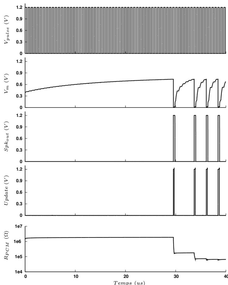
**Figure III.16:** Chronogramme d'une mise à jour de la valeur de la résistance de la PCM lorsqu'il y a corrélation entre une impulsion entrante et une sortante.
