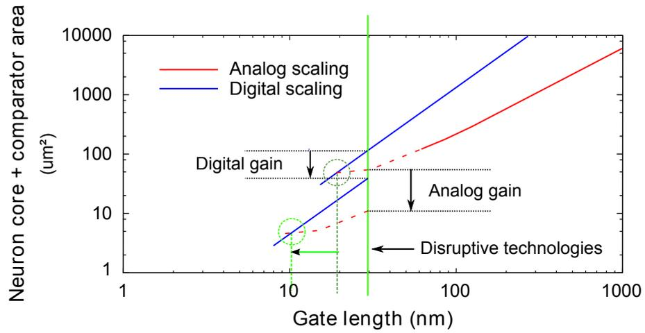
**Figure III.21:** Passage à l'échelle envisagé de neurones LIF : évolution probable des implémentations analogiques et numériques selon le nœud technologique. L'impact des technologies émergentes permet de repousser le point d'équivalence selon les gains procurés aux différentes implémentations.
