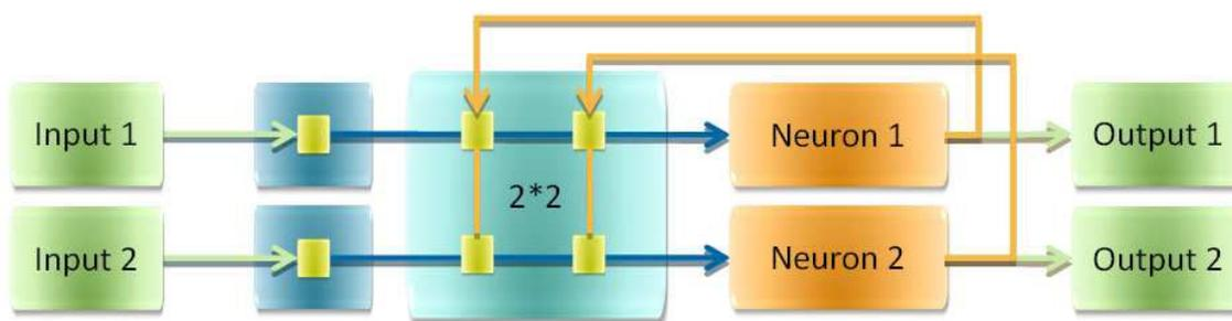
**Figure III.17:** Architecture implémentée pour évaluer le potentiel des CBRAMs. Deux neurones, une matrice 2\*2 de CBRAM pour leur interconnexion et deux CBRAMs pour la stimulation des neurones de l'extérieur.
