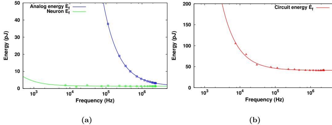
**Figure II.34:** Caractérisation de l'énergie d'un spike dans le circuit *Reptile* : (a) En vert, énergie d'un neurone permettant de générer une impulsion. En bleu, énergie consommée par la partie analogique (tuiles de neurones, miroir d'alimentation des tuiles). (b) Énergie totale d'une boucle numérique+analogique pour générer une impulsion.
