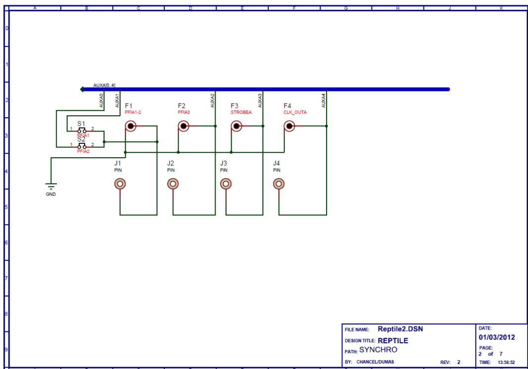
En haut : brochage pour connecteur au châssis de caractérisation. En bas : signaux de synchronisation.
