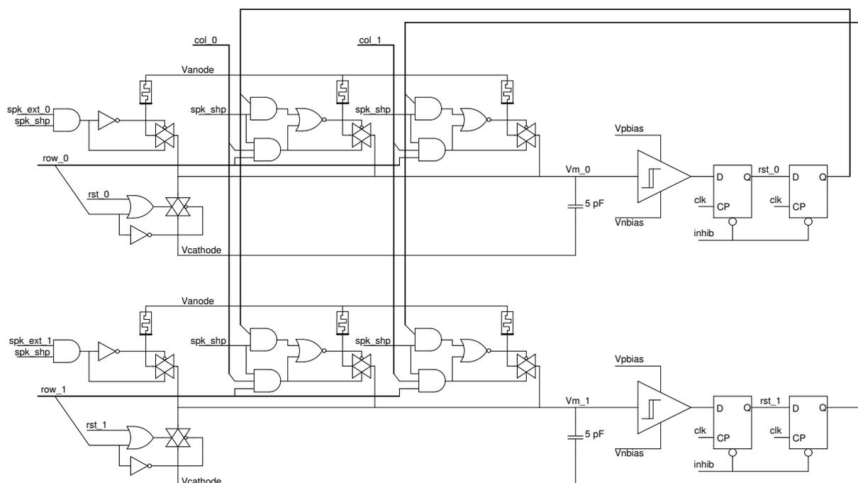
**Figure III.18:** Détails de l'architecture implémentée. On retrouve les six CBRAMs, et les deux neurones. Ces derniers sont constitués d'une capacité, d'un comparateur, de deux bascules et d'une remise à zéro.
