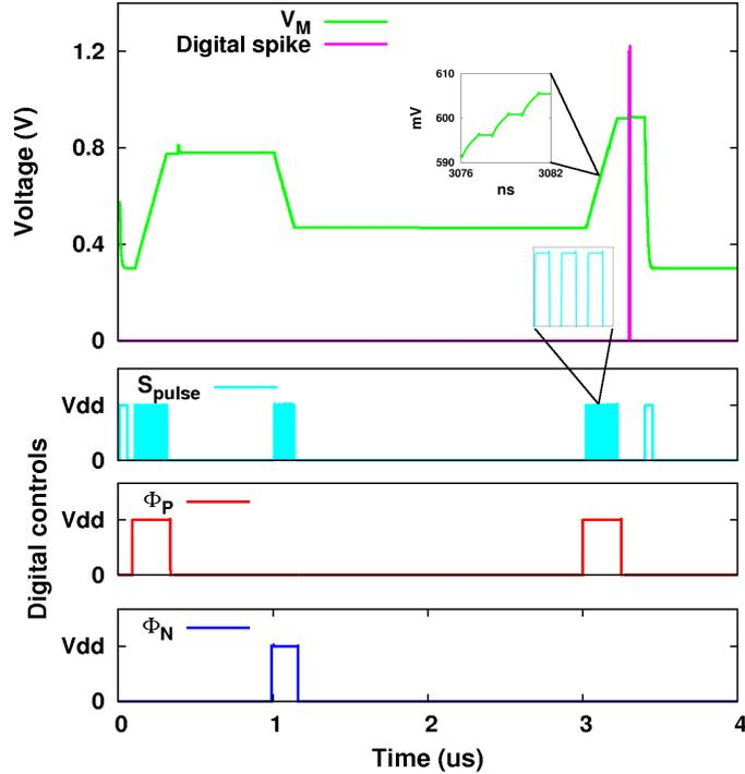
**Figure II.22:** Évolution du potentiel de membrane  $V_m$  et sortie numérique du neurone. Le neurone est configuré en mode IF, ses principaux signaux de contrôle numérique permettent l'injection de 3 poids consécutifs : respectivement  $+0.8$ ,  $-0.5$ , et  $+0.8$ .
