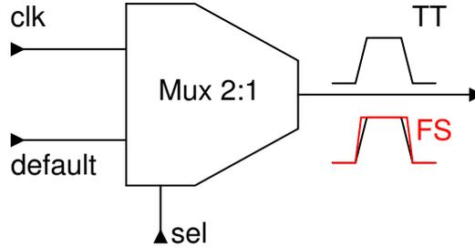
**Figure II.12:** Effets de la variabilité sur un MUX 2 :1. La largeur de l'impulsion délivrée varie selon la fabrication. Lorsque le signal d'horloge est sélectionné par le multiplexeur, le créneau de sortie peut avoir deux formes suivant les caractéristiques des transistors (ici TT et FS).
