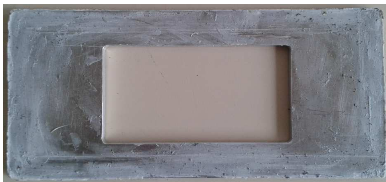
FIGURE 6.14 – Diaphragme sans chanfrein placé dans le conduit.
