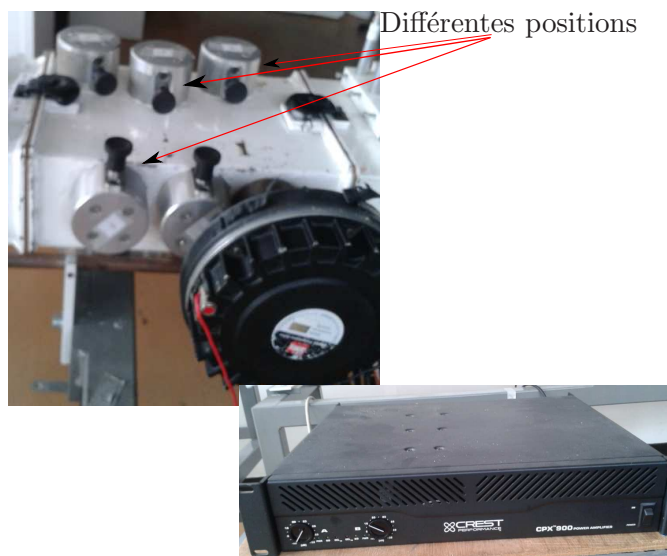
FIGURE B.5 – Tronçon pour différentes configurations de haut-parleur.
