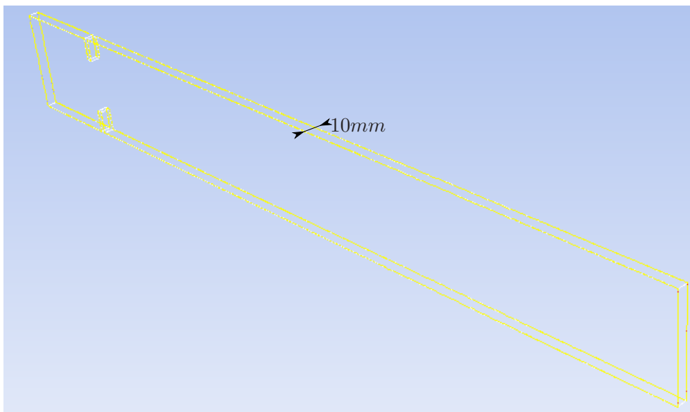
FIGURE 5.2 – Géométrie du modèle 2D slice du diaphragme.
