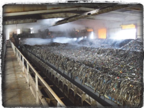
(b) Andains de fermentation des déchets
