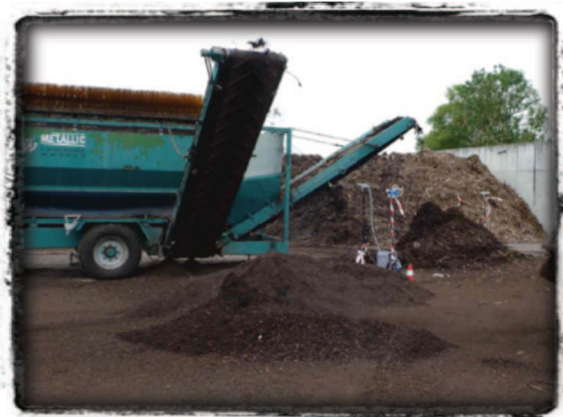
(d) Criblage du compost (cribleuse mobile)
