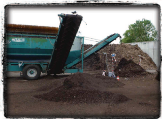
(d) Criblage du compost (cribleuse mobile)
