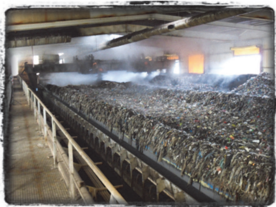
(b) Andains de fermentation des déchets
