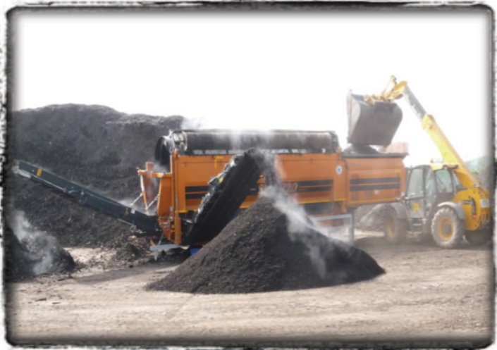
(e) Criblage du compost (cribleuse mobile)
