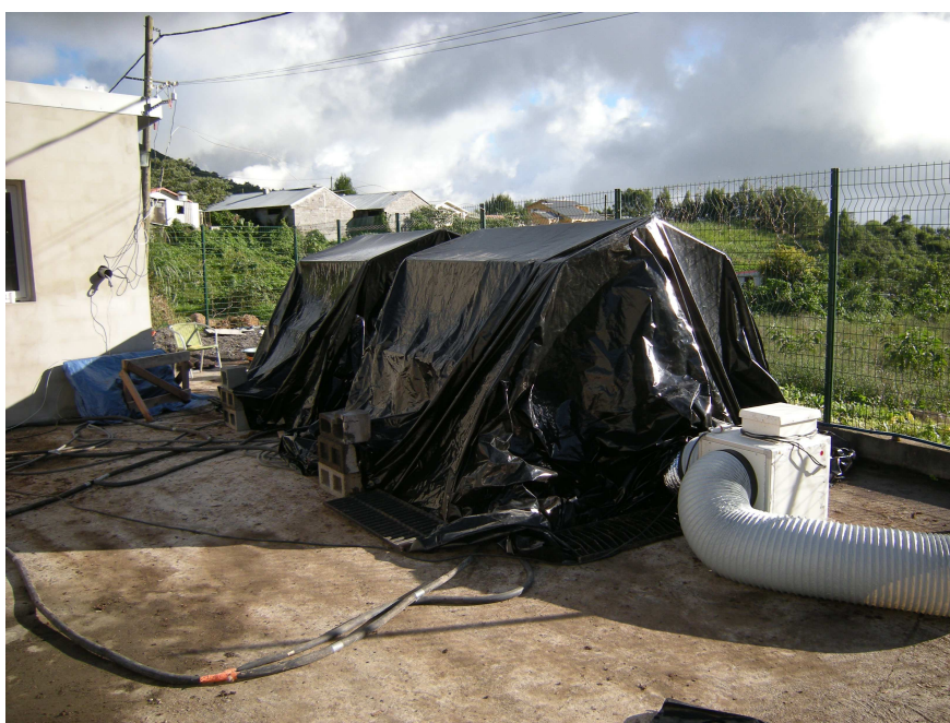
Figure 24. Cellules de mesure des concentrations gazeuses pour deux andains
