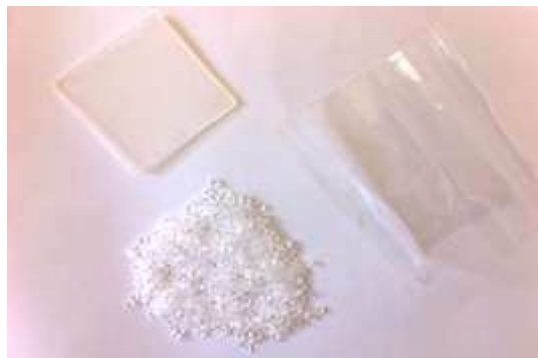
Figure 22 : les différentes formes de COC utilisées dans l'étude (plaques, films, granulés)
