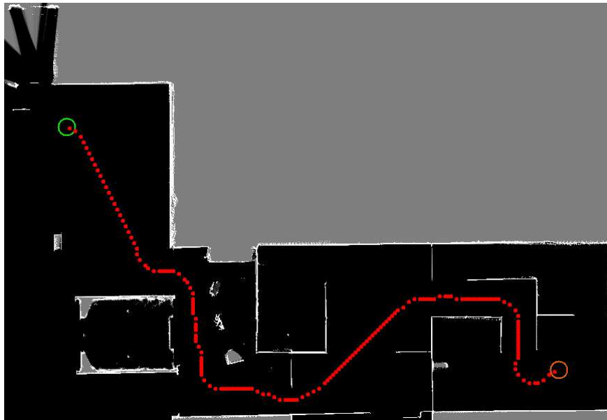
FIGURE 8.8 – Illustration du chemin calculé avec le A* 4D utilisant la vague comme heuristique et la pénalisation des cellules proches des obstacles.
