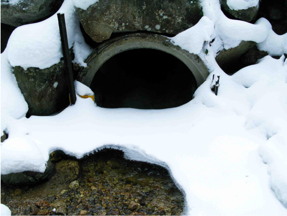
Le seuil Q3 en hiver, lors du gel partiel du seuil et de la sonde piézométrique. L'hiver particulièrement rigoureux de février 2012 a engendré une perte de donnée en raison du gel de la sonde et de son tube de protection. En effet, contrairement au seuil Q1 où l'eau est plus chaude que l'air en hiver, l'eau de la rivière se refroidit le long du cours d'eau, gelant dans les zones où il y a peu de courant. Cliché G. Bouron.
