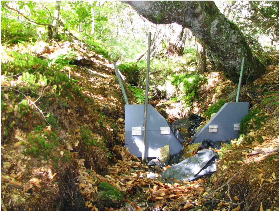
Le seuil Q1 en période d'étiage, lors de l'été 2012. Les débits peuvent être particulièrement faibles en été (exemple de l'été 2011), provoquant l'émergence de la sonde piézométrique et une perte de l'enregistrement des débits. Photo G. Bouron.
