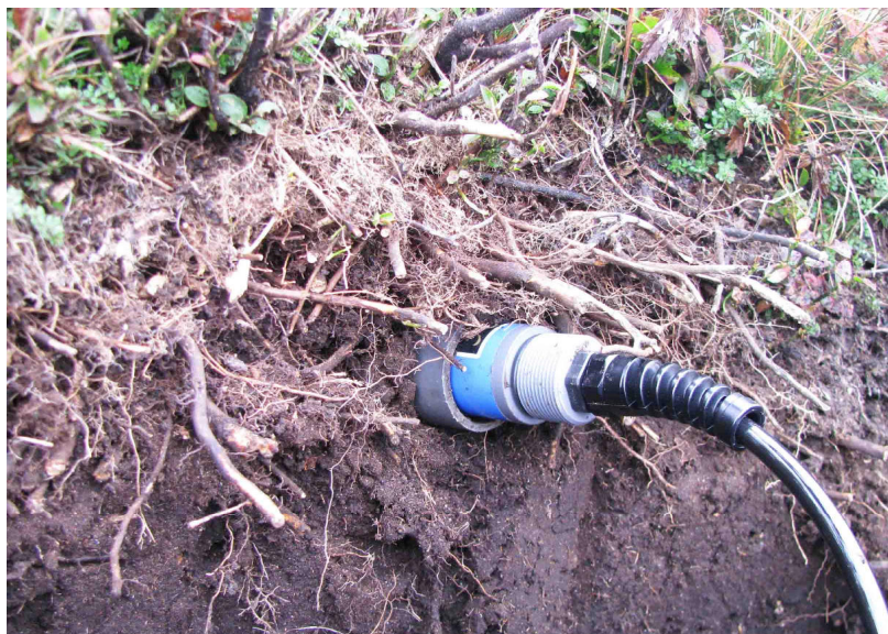
Détail de l'installation d'une sonde TDR dans le sol, ici dans les premiers centimètres de sol, sous les racines de la lande arbustive. Photos G. Bouron.
