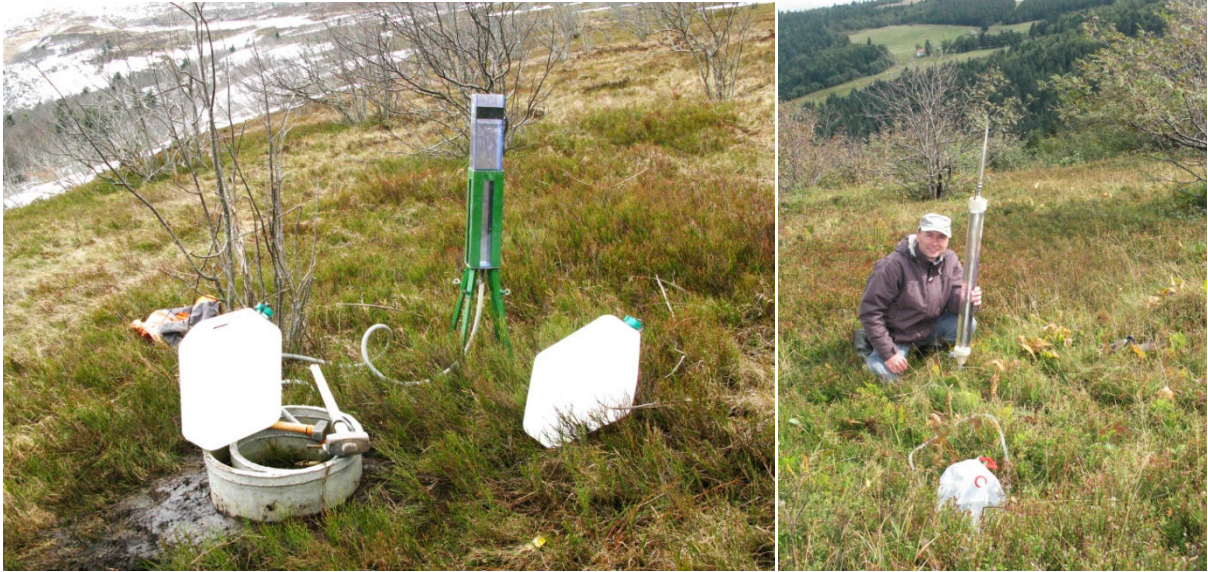
Dispositifs de mesure de la perméabilité du sol. Le double anneau (photo de gauche) permet d'avoir une bonne estimation des perméabilités de la surface. Le perméamètre de Guelph (photo de droite) permet d'investiguer à de plus grandes profondeurs, tant qu'un trou est réalisable à l'aide d'une tarière. Photos G. Bouron.
