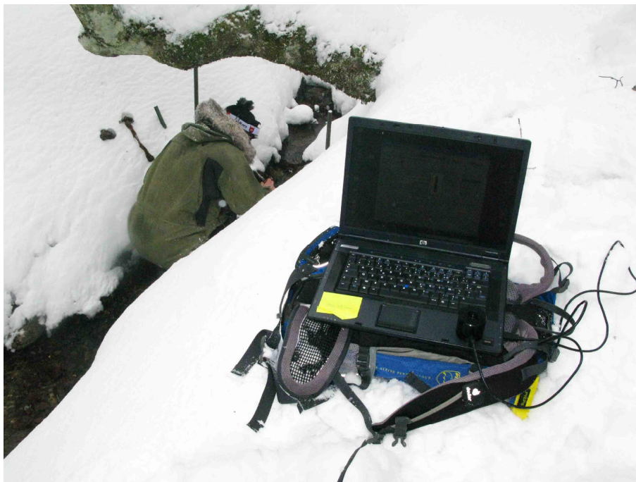
Le seuil Q1 en hiver, lors d'un relevé des données enregistrées par les sondes. La proximité du seuil par rapport à la source permet d'avoir un écoulement qui n'est quasiment jamais affecté par le gel, ce qui n'est pas le cas à Q3. Cliché J. Villot.
