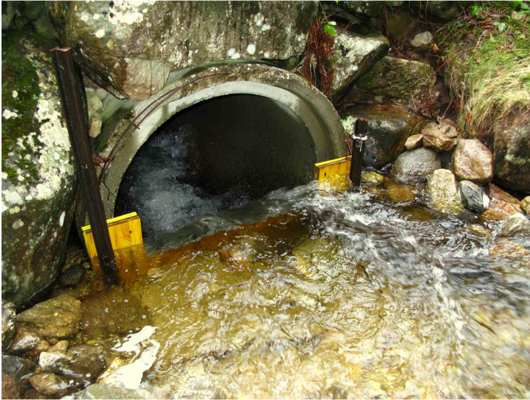
Figure 38 : Photo du seuil Q3 en début d'automne 2012. La sonde piézométrique est installée sur le côté du seuil, en dehors de la zone de remous, et protégée du courant par un tube crépiné en PVC. D'autres images d'illustration sont présentées en Annexe G2. Cliché G. Bouron.
