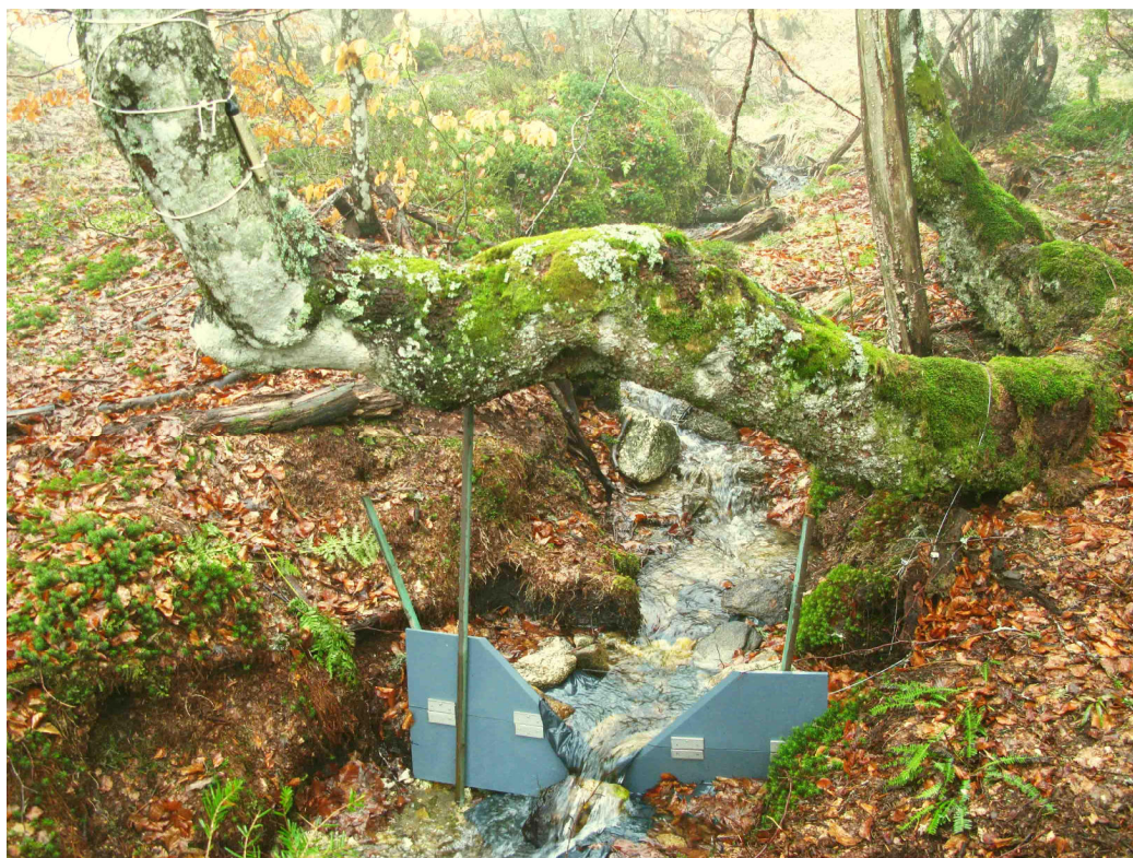
Figure 36 : Photo du seuil Q1 et de la sonde barométrique (sur la branche) à l'automne 2012. L'Annexe G2 présente des illustrations supplémentaires. Cliché G. Bouron.
