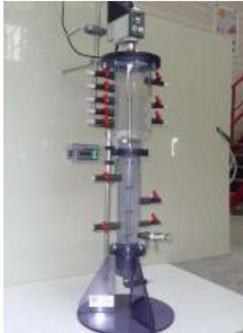
Figure 1.17 : Photographie du réacteur à lit fluidisé.
