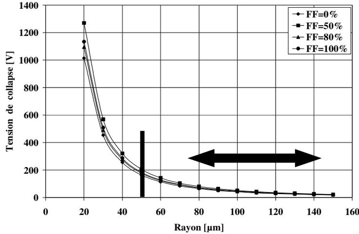
Figure.2. 2. Variations de la tension de collapse en fonction du rayon de la membrane pour différentes valeurs du facteur de remplissage FF de l'électrode supérieure.
