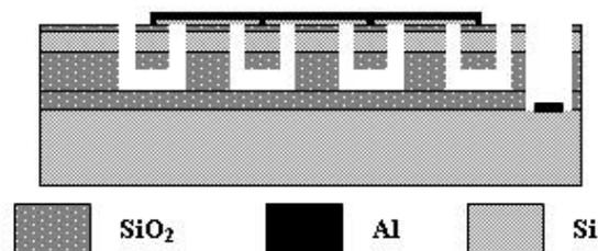
Figure.1. 15. Représentation schématique d'un CMUT-piston [46].
