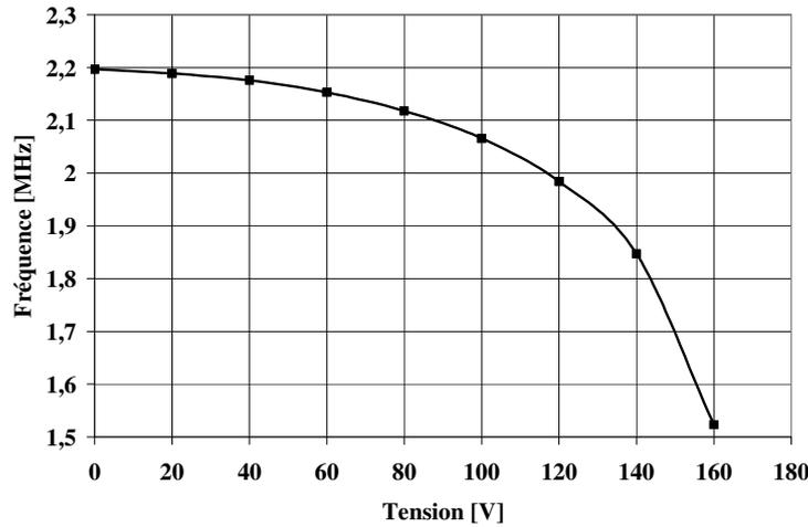
Figure.2. 14. Variation de la fréquence propre fondamentale en fonction de la tension appliquée pour une membrane avec  $r=50\mu\text{m}$  pour  $FF=0\%$ .
