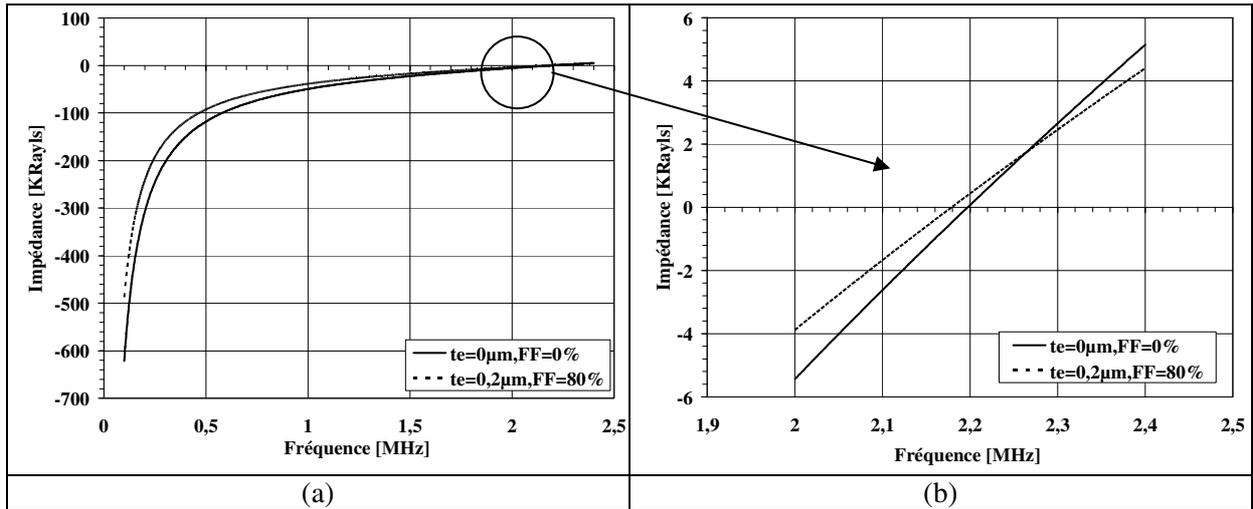
Figure.2. 16. Variation de l'impédance mécanique d'une membrane CMUT avec  $R=50\mu m$  pour les deux configurations  $FF=0\%$  et  $FF=80\%$ , en fonction de la fréquence (a)Vue globale (b) Vue agrandie.
