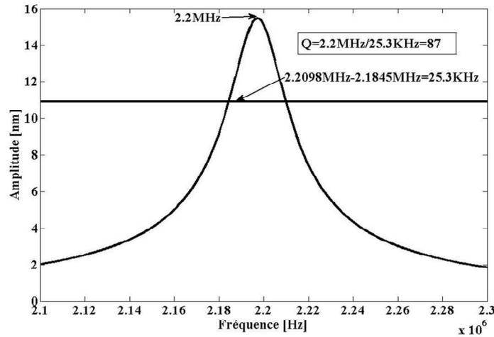
Figure.2. 15. Réponse fréquentielle d'une membrane CMUT avec  $R=50\mu\text{m}$ ,  $FF=0\%$  et  $V_{DC}, V_{ac}=10V$ .
