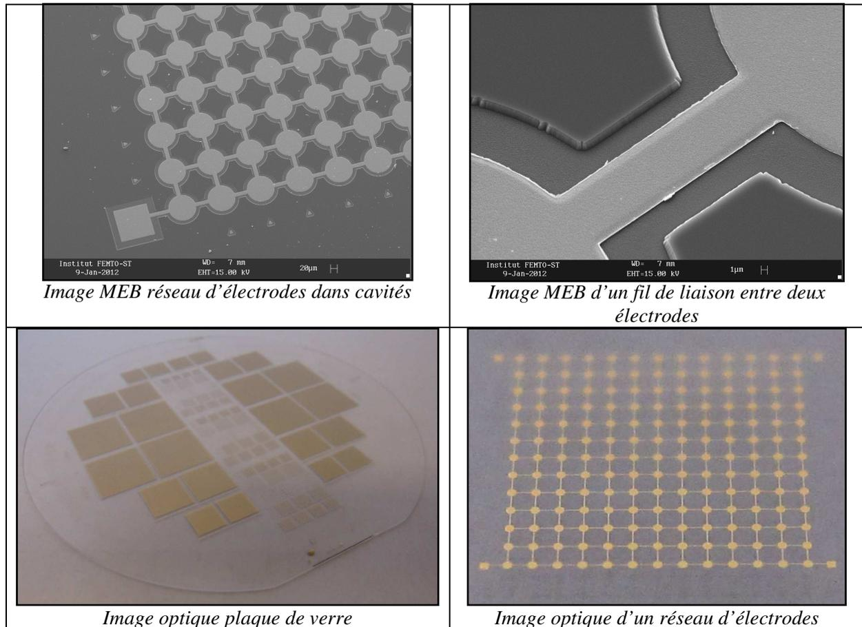
Image MEB réseau d'électrodes dans cavités
