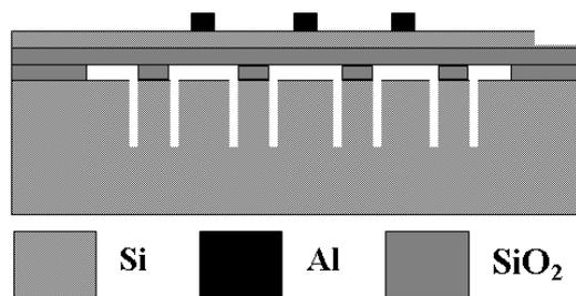
Figure.1. 18. Représentation schématique d'un CMUT à supports flexibles [48].
