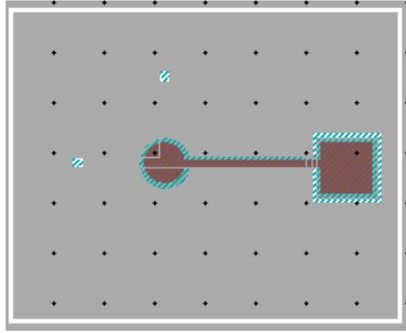
Figure.3. 5. Exemple d'une cellule unitaire de rayon 50  $\mu\text{m}$ .
