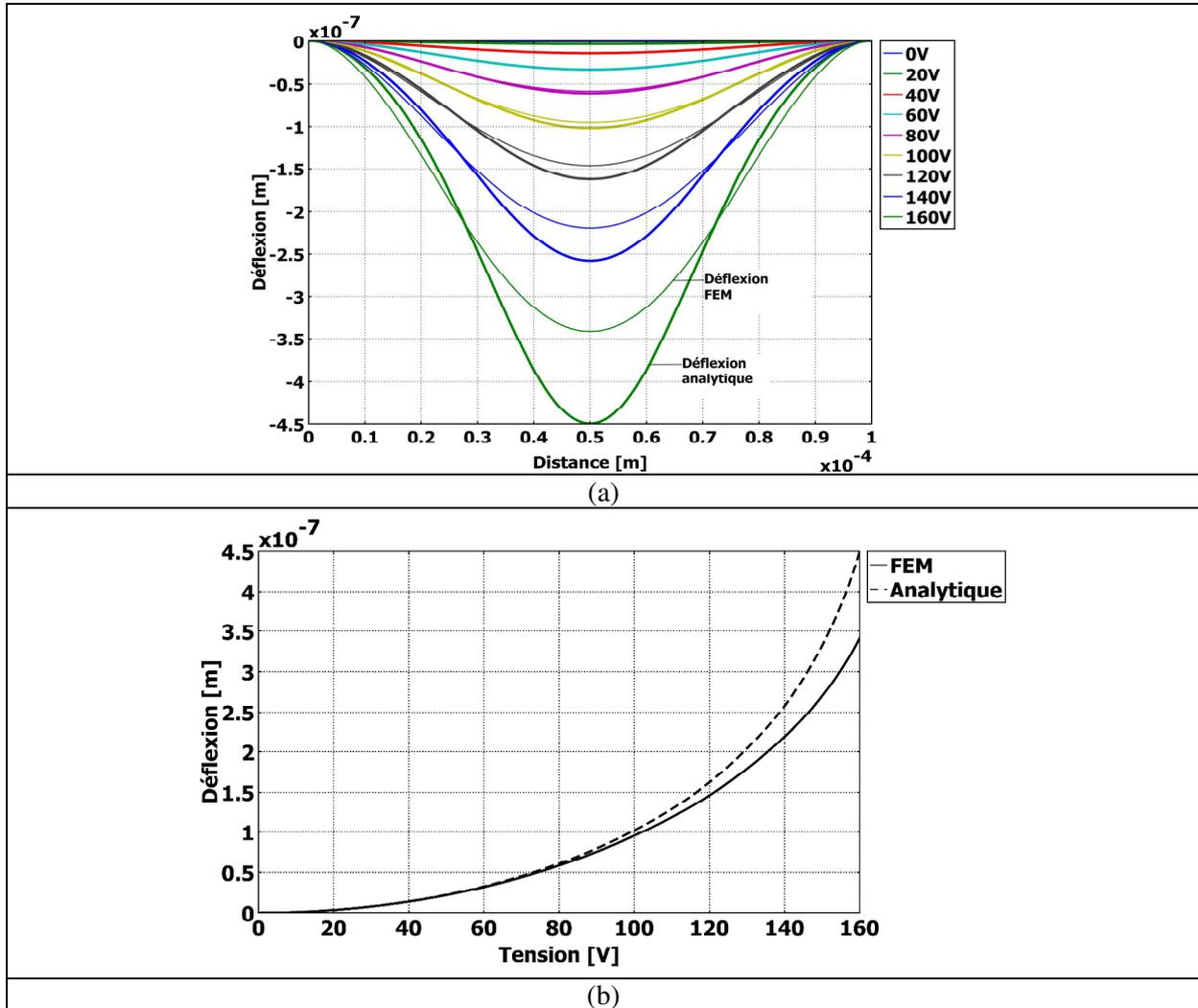
Figure.2. 7. (a) Profils de déflexion (membrane  $R=50\mu\text{m}$  et  $FF=0\%$ ) obtenue analytiquement et par FEM en fonction de la tension appliquée (b) Déplacement du centre de la membrane en fonction de la tension appliquée.
