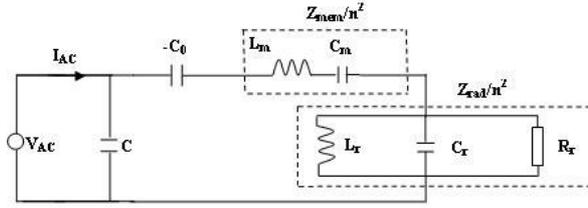
Figure.2. 25. Modèle en circuit électrique équivalent réduit déduit d'une membrane CMUT (50 $\mu$ m, FF=0%).
