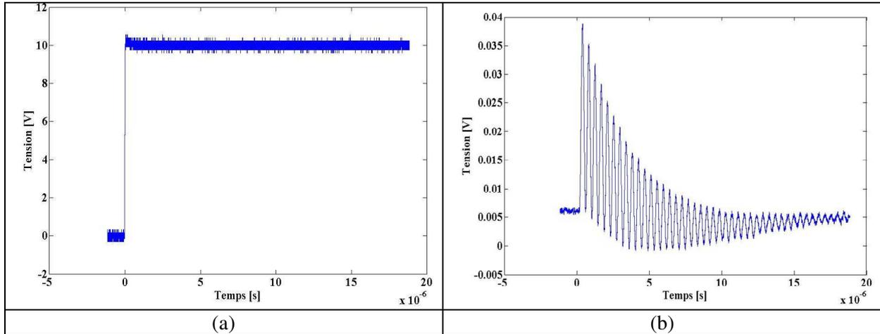
Figure.4. 7. (a) Exemple d'un signal d'excitation échelon utilisé pour la mesure de la réponse indicielle d'une cellule élémentaire d'épaisseur de membrane 1.5 $\mu$ m et de rayon 50 $\mu$ m (b) réponse indicielle de la cellule.
