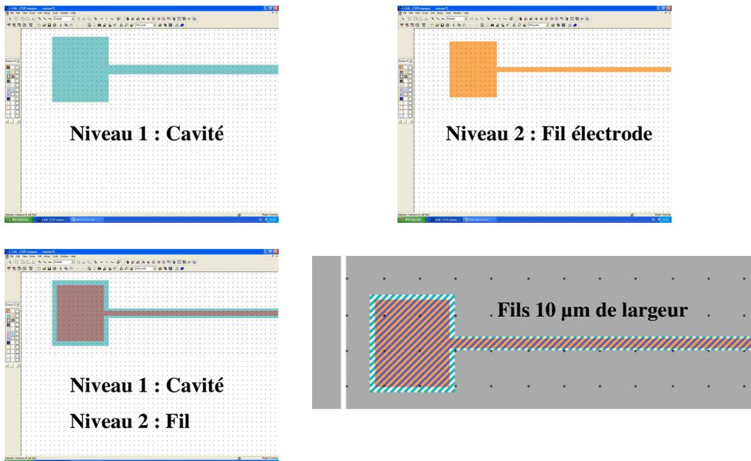
Figure.3. 3. Tests relatifs au dépôt de l'électrode inférieure.
