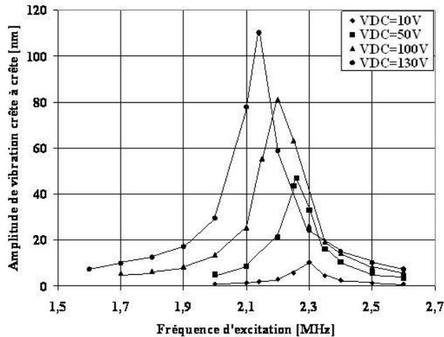
Figure.4. 15. Amplitude de vibration crête à crête au centre d'une membrane avec  $R=50\mu\text{m}$  et  $t_m=1.5\mu\text{m}$  en fonction de la fréquence d'excitation pour différentes tensions de polarisation.
