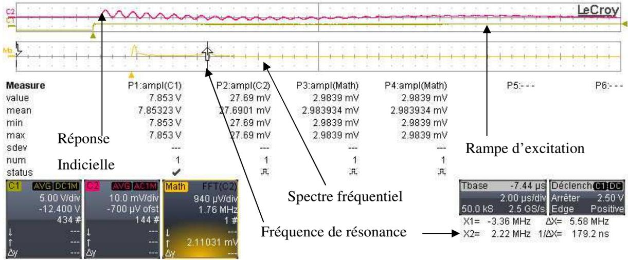
Figure.4. 8. Relevé expérimental obtenu à l'oscilloscope de la transformée de Fourier rapide de la réponse indicielle d'une cellule CMUT ( $R=50\mu\text{m}$ ,  $t_m=1.5\mu\text{m}$ ).
