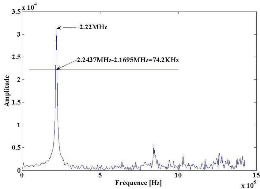
Figure.4. 9. Réponse fréquentielle d'une cellule unitaire ( $R=50\mu\text{m}$ ,  $t_m=1.5\mu\text{m}$ ).
