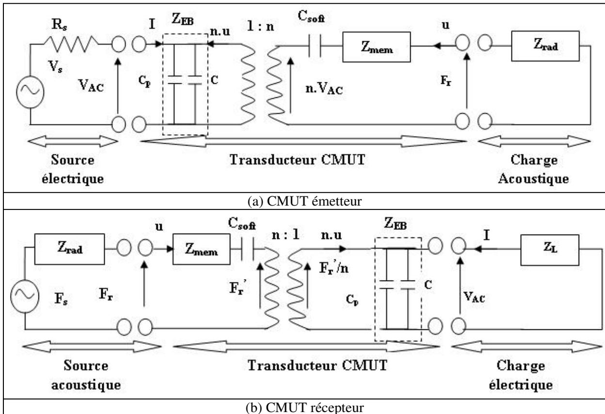
Figure.1. 10. Modèle de Mason pour un CMUT [1].
