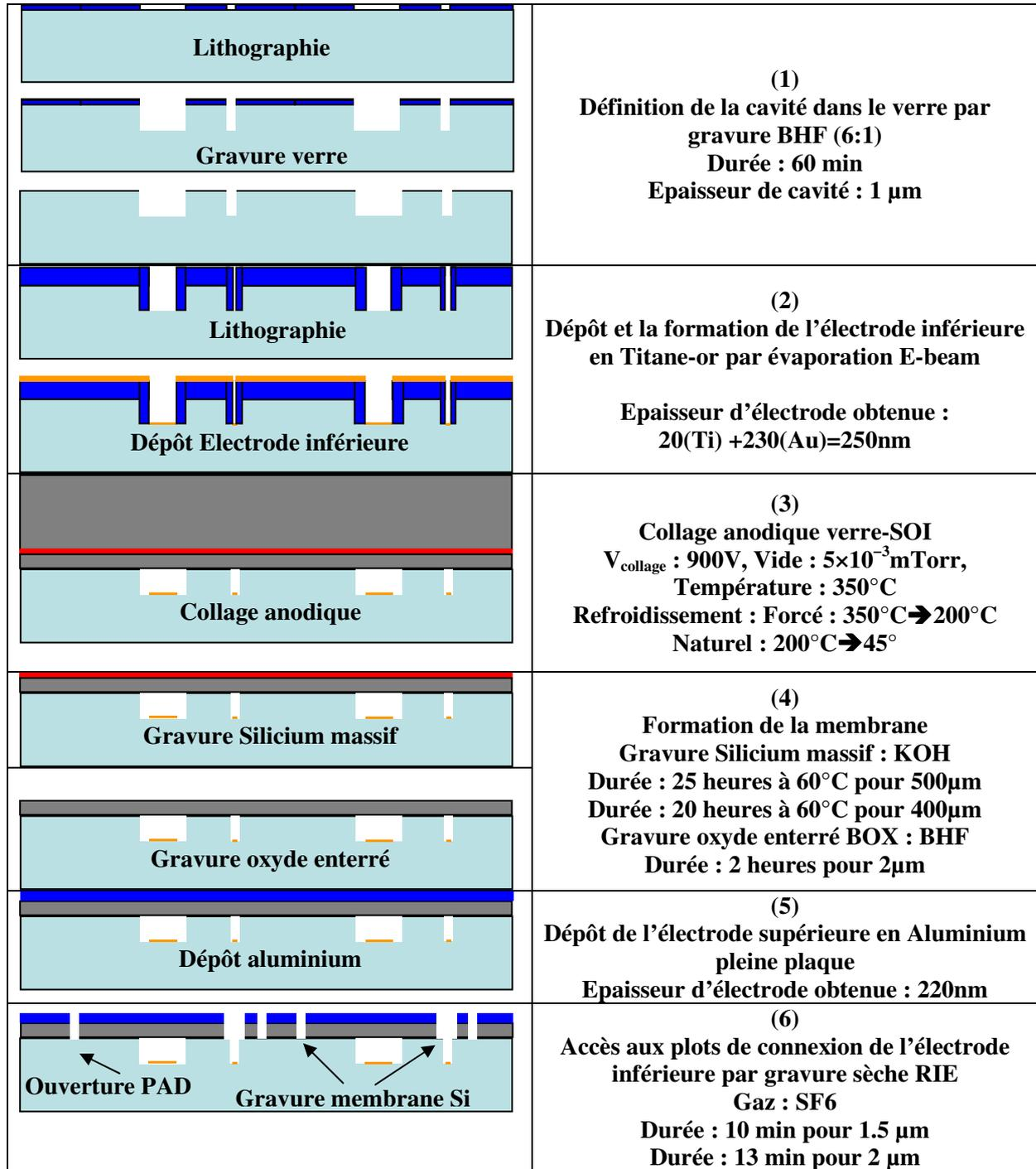
Figure.3. 24. Diagramme séquentiel détaillé du procédé de fabrication.
