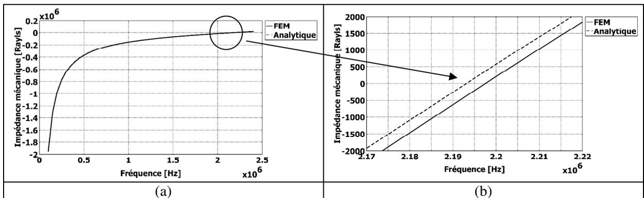
Figure.2. 17. (a) Variation de l'impédance mécanique de la membrane en fonction de la fréquence, calculée en utilisant COMSOL et l'expression analytique (1.36) (b) Vue agrandie sur la région de résonance.
