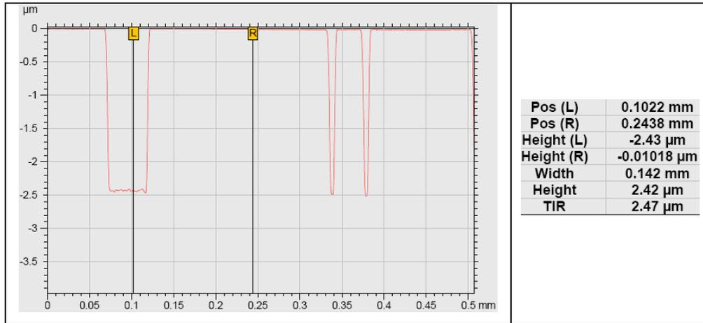
Figure.3. 21. Gravure de la couche de silicium sur une plaque test : la profondeur gravée est 2.43µm.
