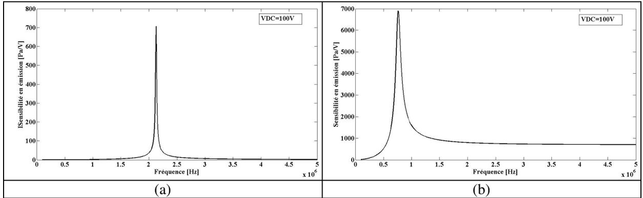
Figure.2. 29. Sensibilité en émission d'une membrane CMUT ( $r=50\mu\text{m}$ ,  $FF=0\%$ ,  $V_{DC}=100\text{V}$ ) simulée dans (a) l'air (b) l'eau.
