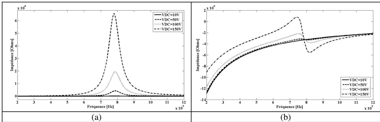
Figure.2. 28. Evolution de l'impédance d'entrée électrique en fonction de la fréquence pour différentes tensions continues appliquées pour une membrane CMUT ( $50\mu\text{m}$ ,  $FF=0\%$ ) fonctionnant dans l'eau (a) partie réelle (b) partie imaginaire.
