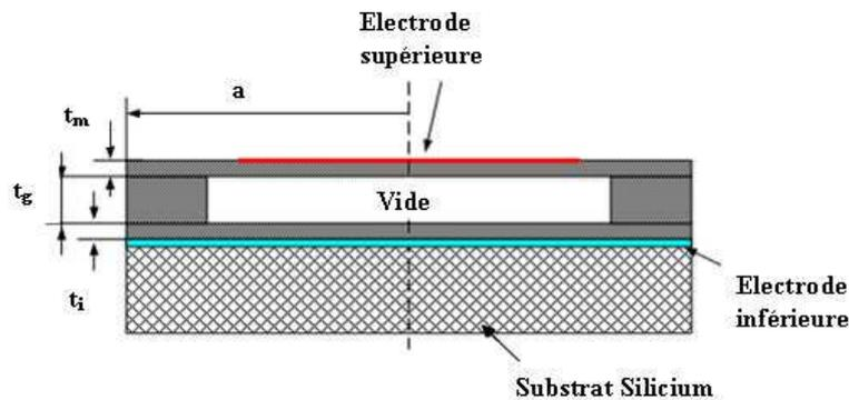
Figure.1. 1. Représentation schématique d'une cellule CMUT [1].
