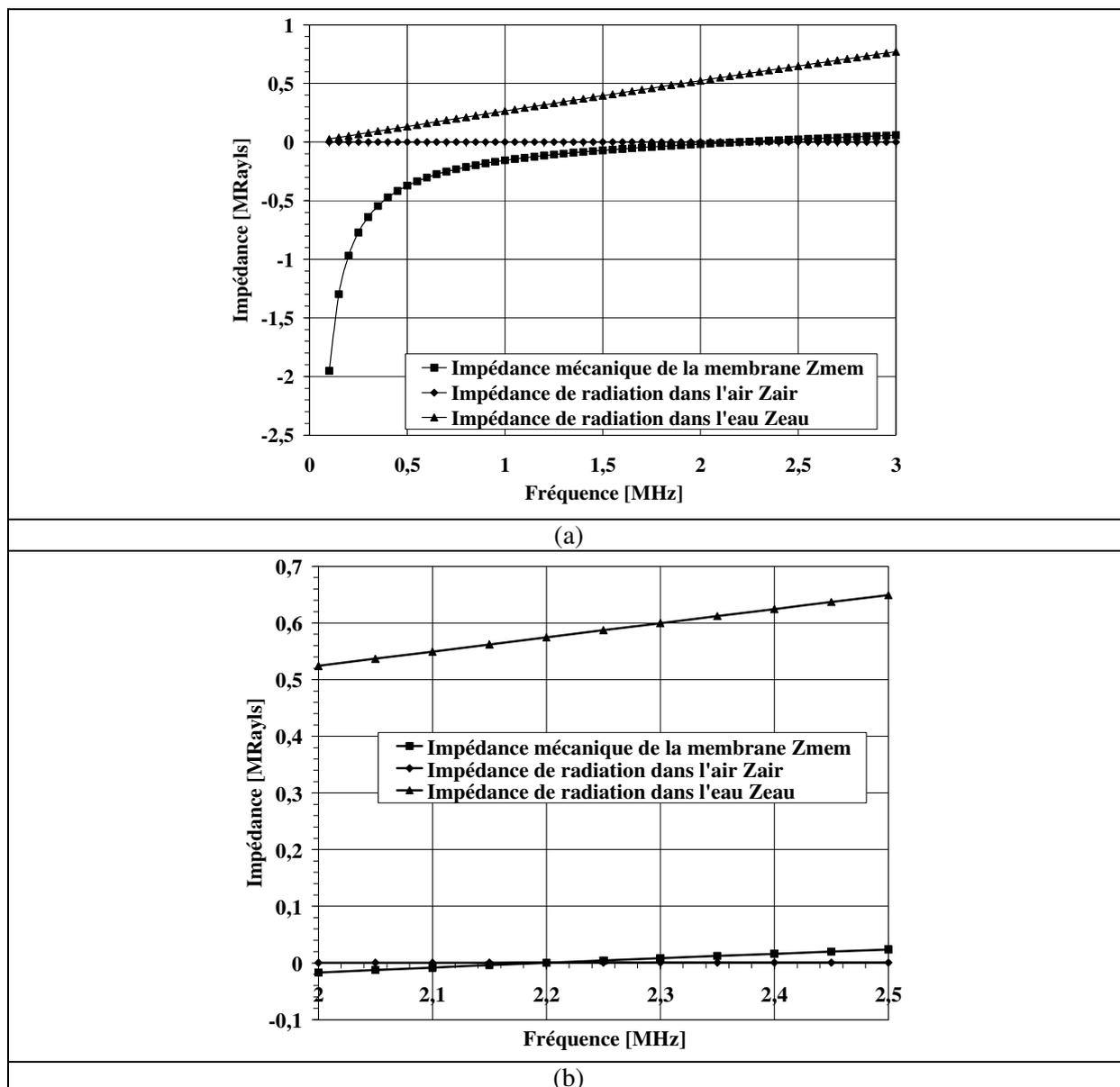
Figure.2. 22. Comparaison entre l'impédance mécanique et les impédances de rayonnement dans l'air et dans l'eau d'une membrane CMUT avec  $R=50\mu\text{m}$  (a) Vue globale (b) Vue agrandie autour de la fréquence de résonance de la membrane.
