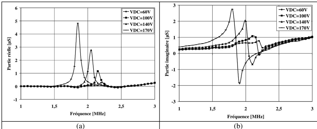
Figure.4. 21. Evolution des parties réelles (a) et imaginaires (b) de l'admittance d'entrée électrique d'une cellule CMUT ( $R=50\mu\text{m}$ ,  $t_m=1.5\mu\text{m}$ ) pour différentes valeurs de tension appliquées.
