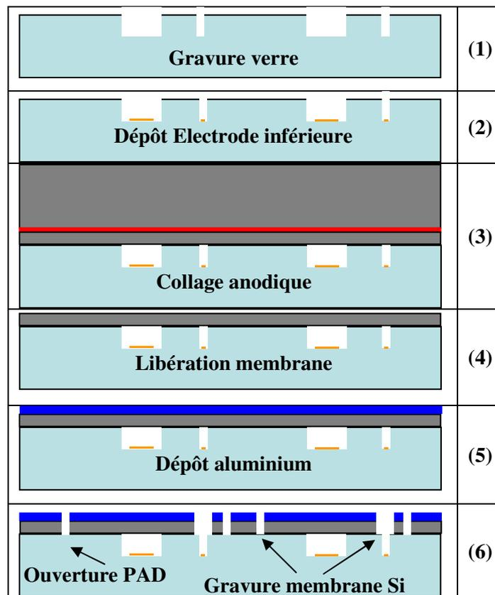
*Figure.3. 1. Diagramme séquentiel du procédé de fabrication.*
