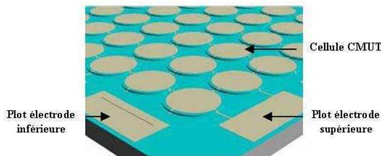
Figure.1. 2. Représentation schématique d'un réseau de CMUT [14].
