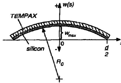
Figure.1. 23. Courbure caractéristique d'un collage anodique silicium/verre Schott borofloat33 [63].
