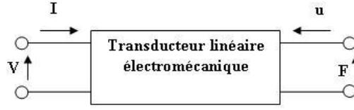
*Figure.1. 9. Représentation quadripolaire des transducteurs électromécaniques [7].*
