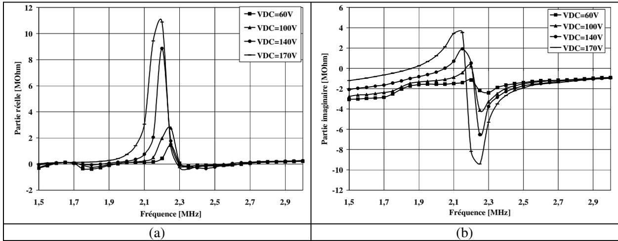
Figure.4. 20. Evolution des parties réelles (a) et imaginaires (b) de l'impédance d'entrée électrique d'une cellule CMUT ( $R=50\mu\text{m}$ ,  $t_m=1.5\mu\text{m}$ ) pour différentes valeurs de tension appliquées.
