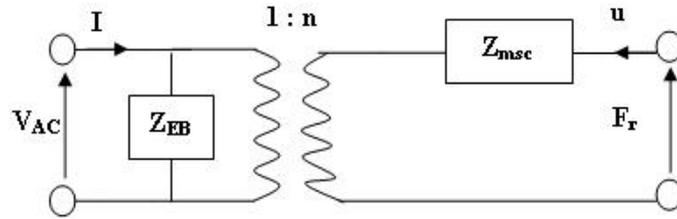
Figure.1. 11. Circuit équivalent pour un CMUT linéaire utilisant les paramètres impédances [26].
