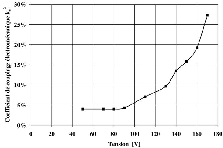
Figure.4. 24. Coefficient de couplage électromécanique mesuré pour une cellule unitaire
