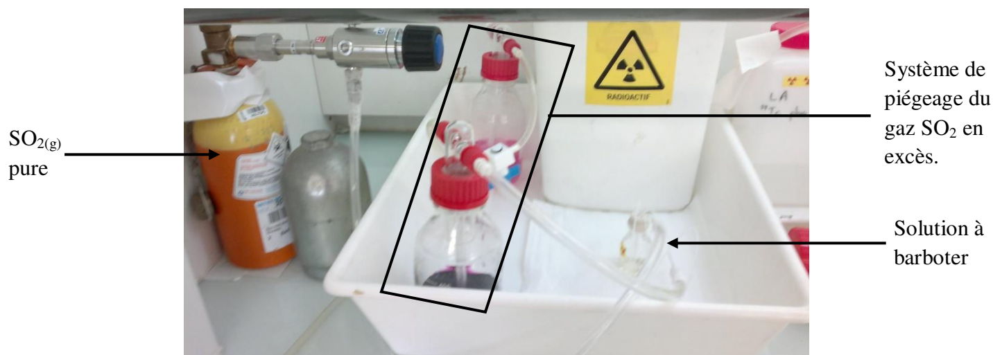
Figure A.1. Dispositif expérimental du système de barbotage avec SO 2(g) .
