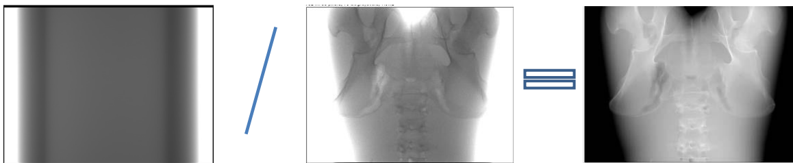
Figure 27: Méthode de normalisation des projections par un fantôme uniforme
