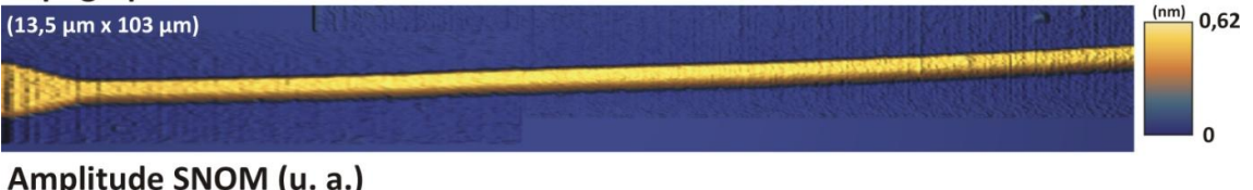
Figure 119 : Cartographie de la topographie de surface et image 2D de la distribution en amplitude SNOM sur un guide d'onde DLSP de largeur 1200nm et d'épaisseur 472,8nm déposé sur un substrat de MgO
