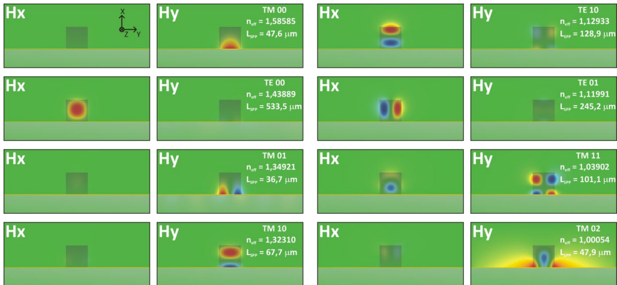
Figure 30 : Modes dans un guide d'onde DLSPP de section 1,2 \times 1,2 \mu\text{m}^2
