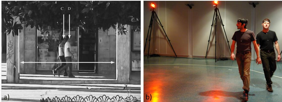
**Figure 5** – Acquisition de données d’interactions physiques dans une tâche de locomotion grâce a) à une caméra vidéo placé sur un tronçon de trottoir et b) grâce à un système de capture de mouvements.
