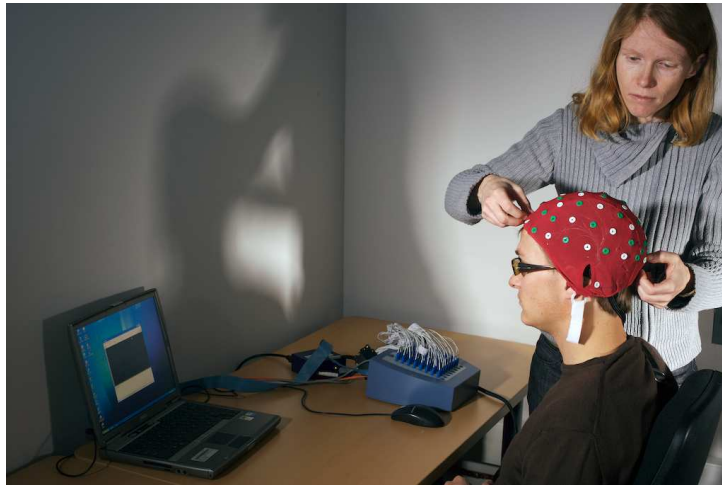
FIG. 1.16: préparation à une prise de mesures EEG (Sources : équipe Athéna INRIA Sophia Antipolis)
