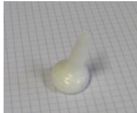
Figure 10: cristal tiré à partir d'un bain contenant des oxyfluorures
