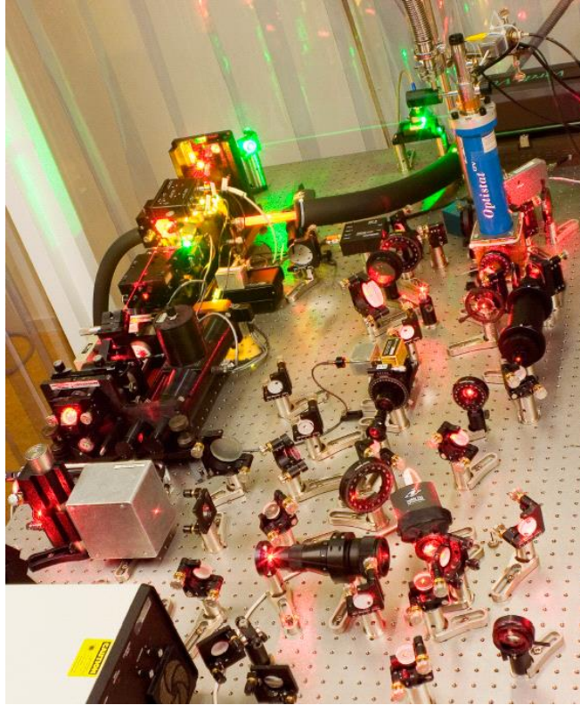
Figure 4: source laser stabilisée pour des applications de traitement quantique de l'information
