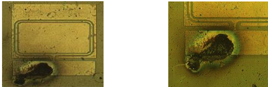
Figure 65 : image des JFET type P après claquage dans l'air sous une tension égale à 100 V.
