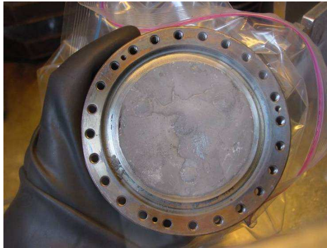
Figure 2.16 : photographie illustrant l'expansion de composites MgH_2 + 5\% GNE après cyclage (réservoir Hystory) : les pastilles occupent l'ensemble du volume interne du réservoir.
