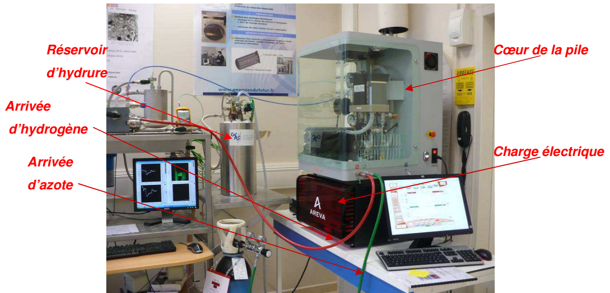
Figure 3.9 : Photographie du couplage Nesshy - Bahia
