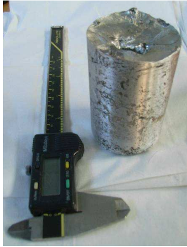
Figure 4.25 : Photographie d'un lingot de MCP montrant une retassure sur la face supérieure.
