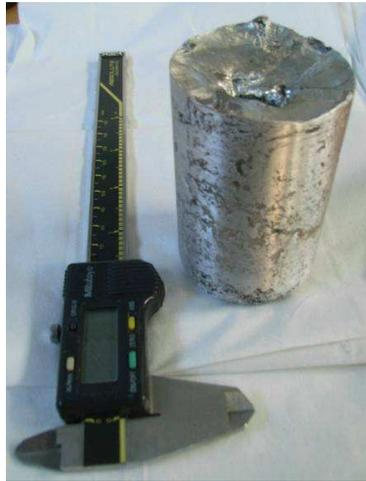
Figure 4.25 : Photographie d'un lingot de MCP montrant une retassure sur la face supérieure.
