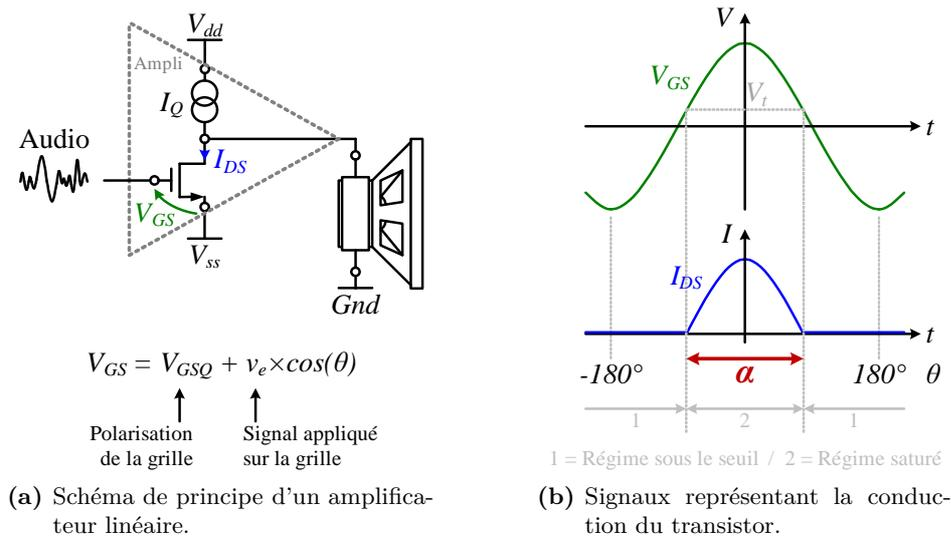
Figure 1.16 – Définition de l'angle de conduction.
