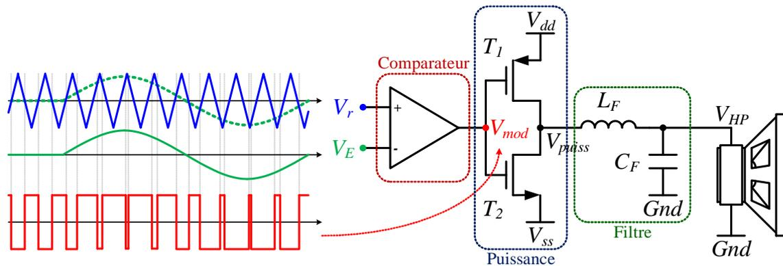
Figure A.1 – Schéma de principe d'un Classe-D MLI.
