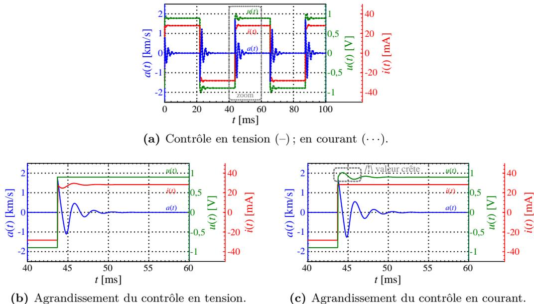
**Figure 3.15** – Analyse transitoire : tension  $u(t)$ ; courant  $i(t)$  et accélération  $a(t)$ .
