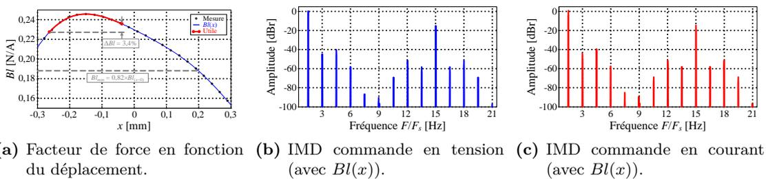
Figure 3.10 – Analyse d'IMD avec comme paramètre non-linéaire :  $Bl(x)$ .
