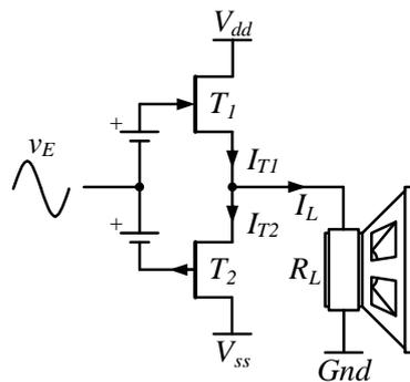
**Figure 1.18** – Schéma de principe du Classe-AB « *push-pull* ».
