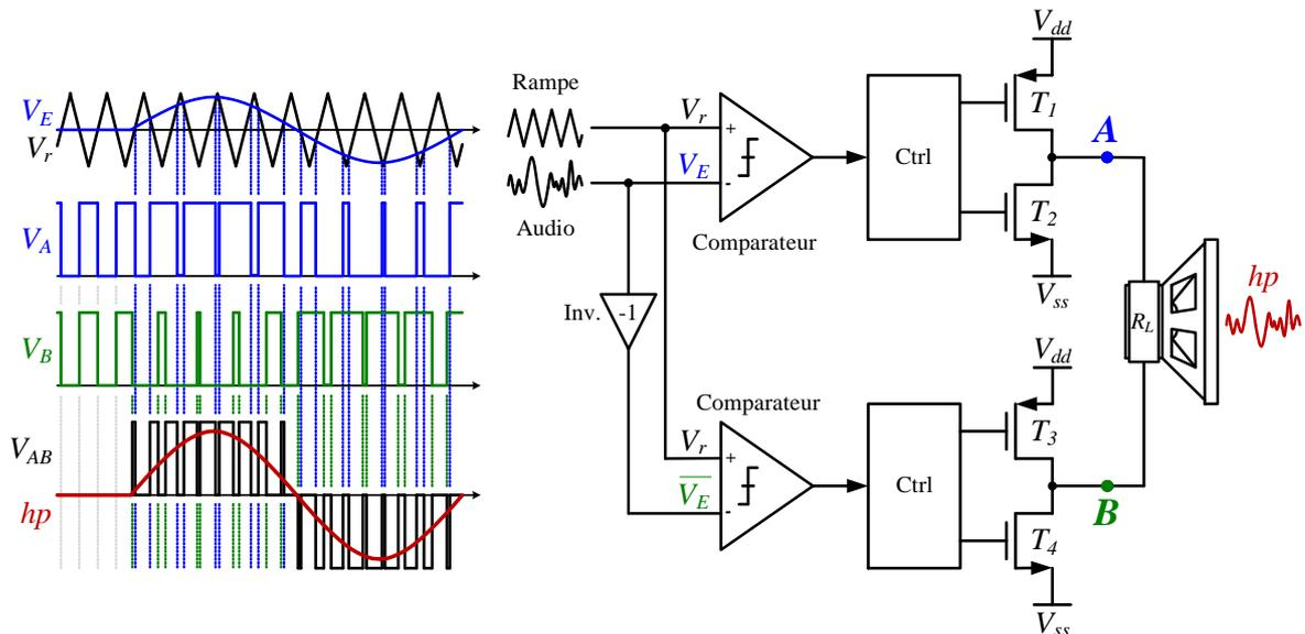
Figure 1.23 – Signaux dans un Classe-D(tern) sans filtre.
