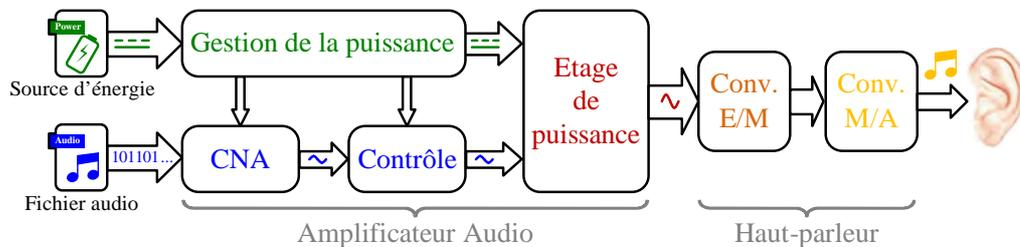
Figure 1.3 – Principe de conversion d'un système audio
