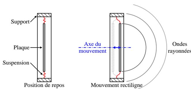
**Figure 1.4** – Schéma du système mécano-acoustique d'un transducteur électroacoustique.
