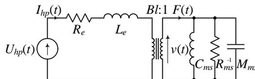
Figure 2.3 – Schéma d'un haut-parleur sur écran infini.
