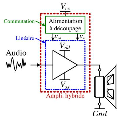
**Figure 1.24** – Schéma de principe d'un amplificateur hybride.
