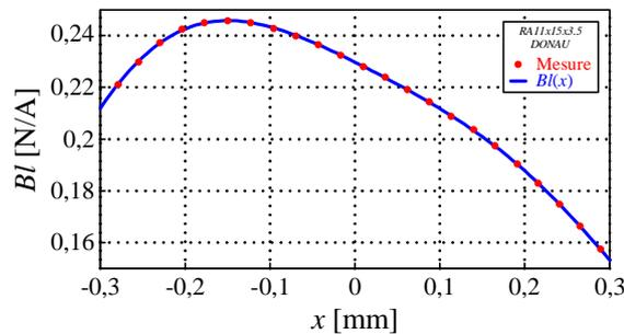
(b) Coefficient de couplage vs. déplacement
