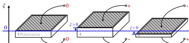
**Figure 1.6** – Schéma des variations d'épaisseur d'une couche de PZT.
