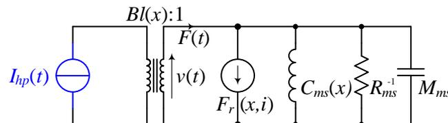
Figure 3.5 – Schéma d'un haut-parleur commandé en courant avec non-linéarités.
