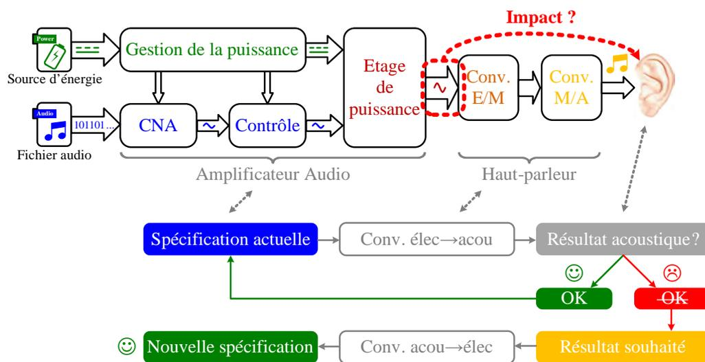
Figure 4.11 – Principe de la démarche globale.
