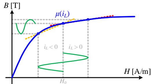
Figure 2.14 – Densité de flux  $B$  par rapport au champ magnétique  $H$ .
