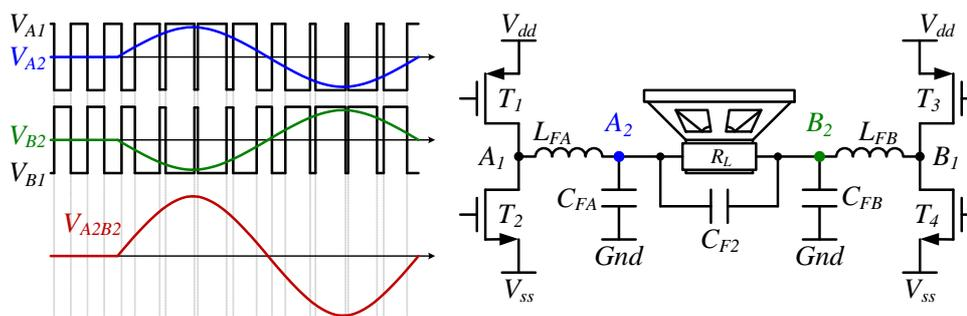
Figure 1.22 – Signaux dans un Classe-D(bin) pont en H.
