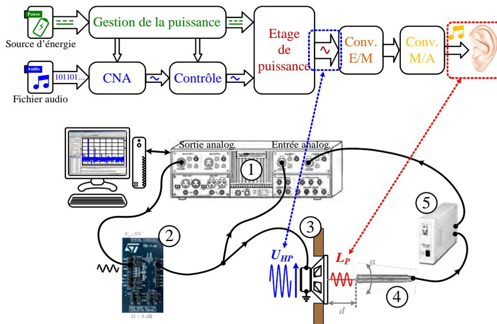
Figure 4.13 – Banc de mesure des distorsions (ampli & haut-parleur).
