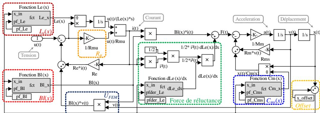
Figure 2.17 – Modèle Simulink d'un haut-parleur avec paramètres non-linéaires.
