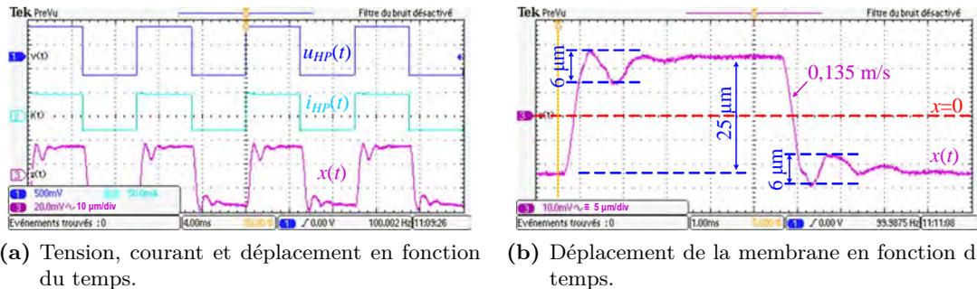
**Figure 5.15** – Réponse à un échelon en tension.
