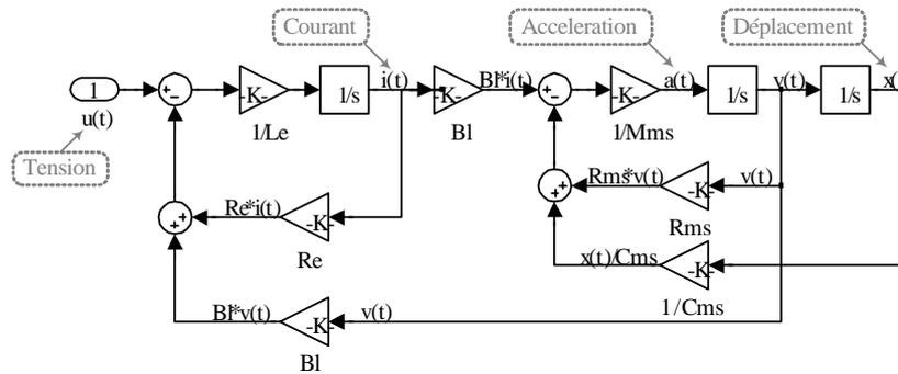
Figure 2.6 – Modèle Simulink d'un haut-parleur électrodynamique.
