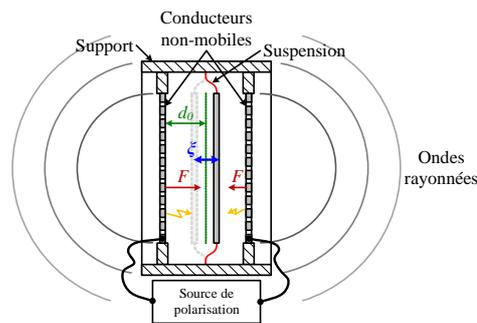
**Figure 1.9** – Schéma de principe d'un haut-parleur électrostatique.
