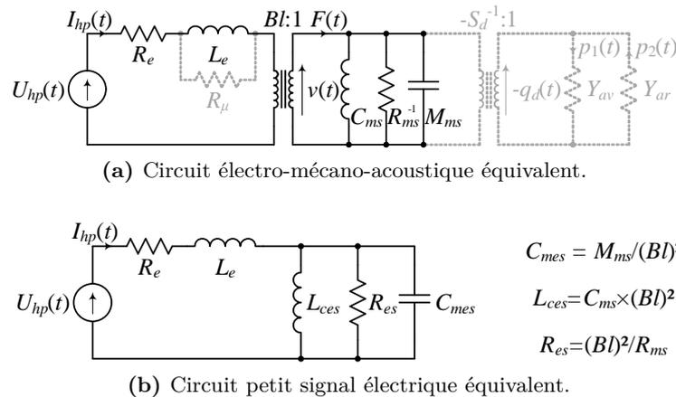
Figure 5.12 – Circuits équivalents en petit signal au MEMS.
