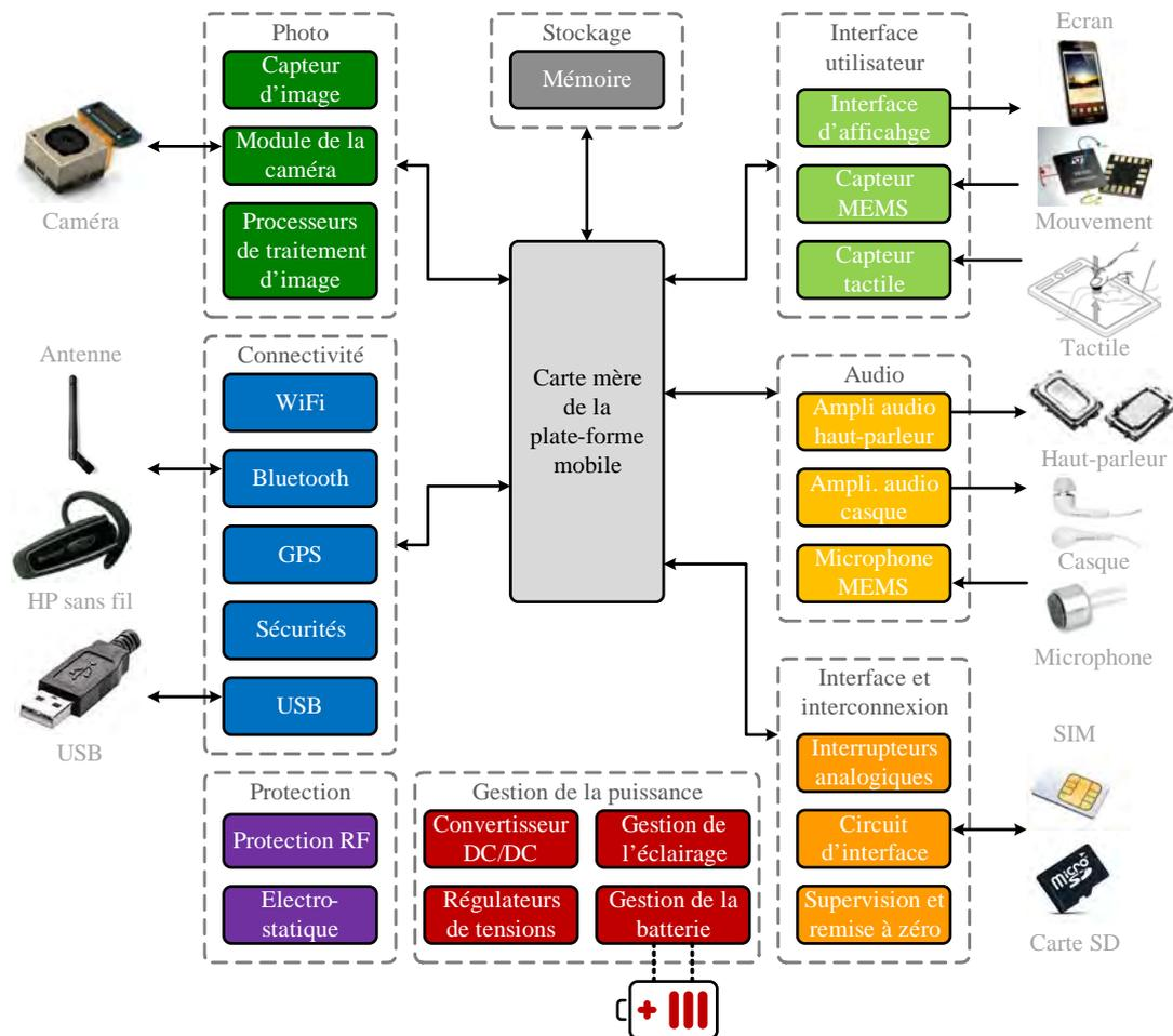
Figure 1.1 – Exemple de plateforme regroupant de multiples fonctionnalités.
