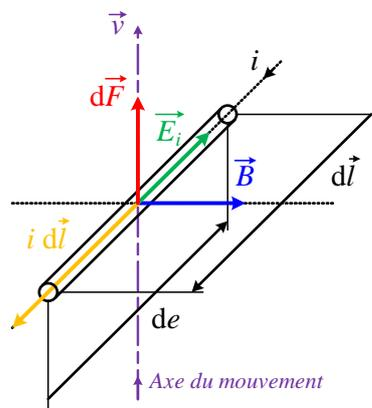
**Figure 1.10** – Schéma de principe de la conversion électrodynamique.
