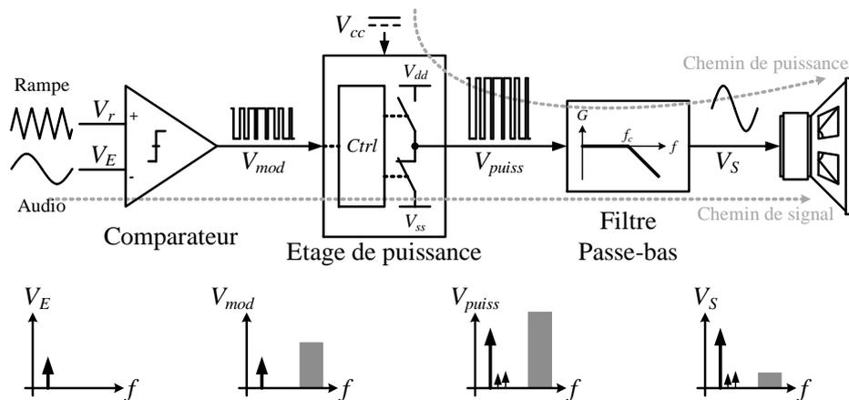
Figure 1.20 – Schéma de principe du Classe-D analogique.
