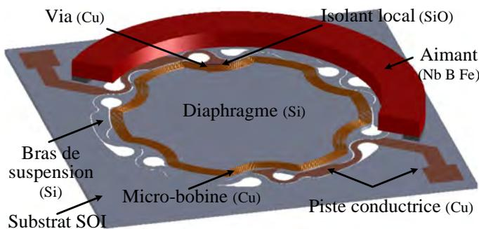
**Figure 5.2** – Structure schématisée du micro-haut-parleur MEMS.
