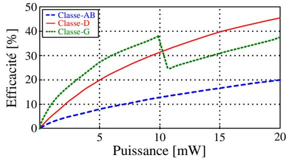
Figure 4.8 – Rendement v.s. puissance, pour différentes topologies.
