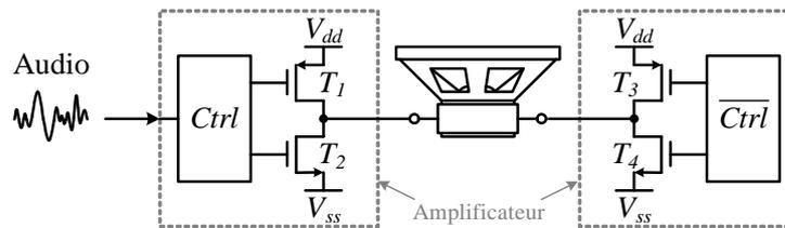
Figure 1.15 – Schéma d'une configuration pont en H.
