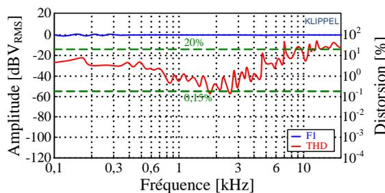
Figure 4.15 – Distorsion en fonction de la fréquence (haut-parleur).
