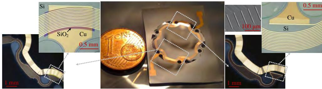
(a) Résultat de la microfabrication avec agrandissement des deux jonctions piste/bobine.
