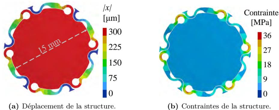
**Figure 5.6** – Déplacement hors-plan et distribution de la contrainte principale dans le cas de la solution à six ressorts.
