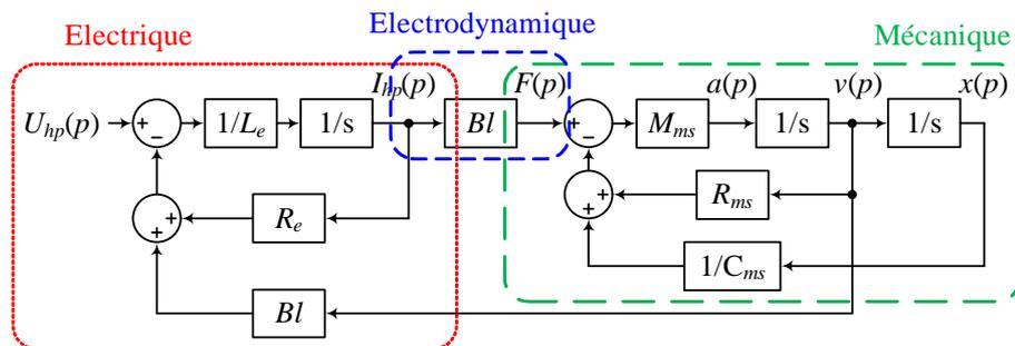
Figure 2.5 – Schéma bloc d'un haut-parleur électrodynamique.
