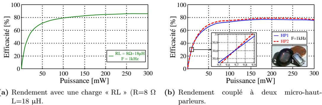
Figure 4.4 – Rendement d'un amplificateur à commutation.
