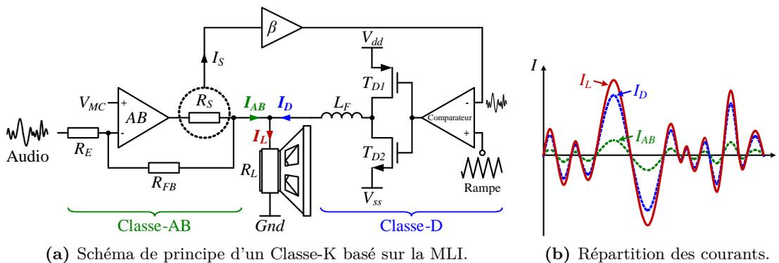
(a) Schéma de principe d'un Classe-K basé sur la MLI.
