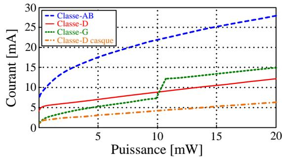
Figure 4.9 – Courant d'alimentation v.s. puissance, pour différentes topologies.
