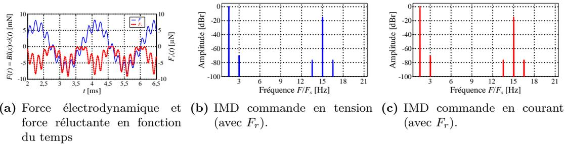
Figure 3.13 – Analyse d’IMD avec comme paramètre non-linéaire :  $F_r$ .
