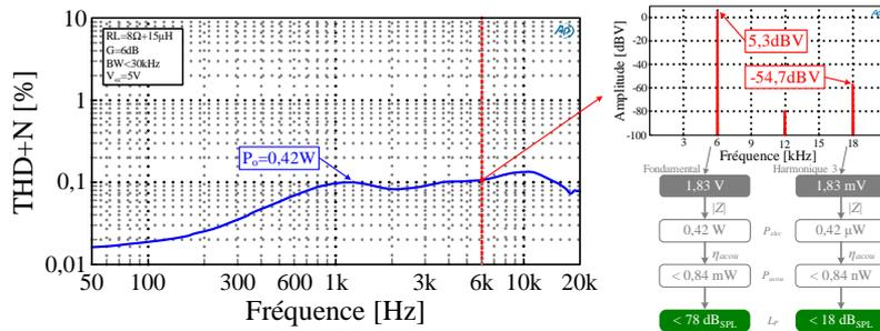
Figure 4.16 – Distorsion en fonction de la fréquence (ampli).
