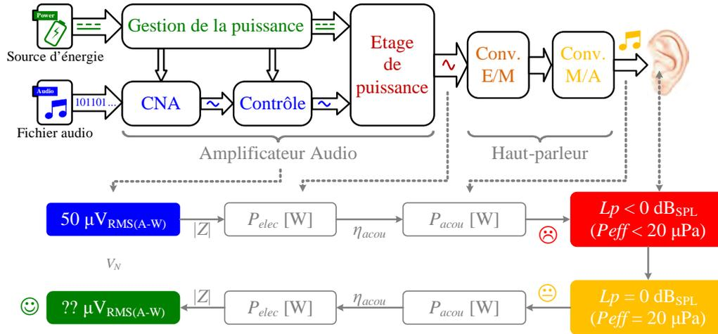
Figure 4.12 – Démarche globale appliquée au bruit en tension.
