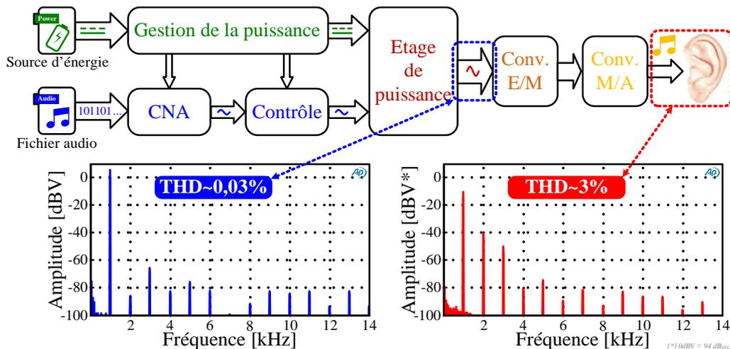
Figure 4.14 – Comparaison des distorsions harmoniques (ampli v.s. haut-parleur)
