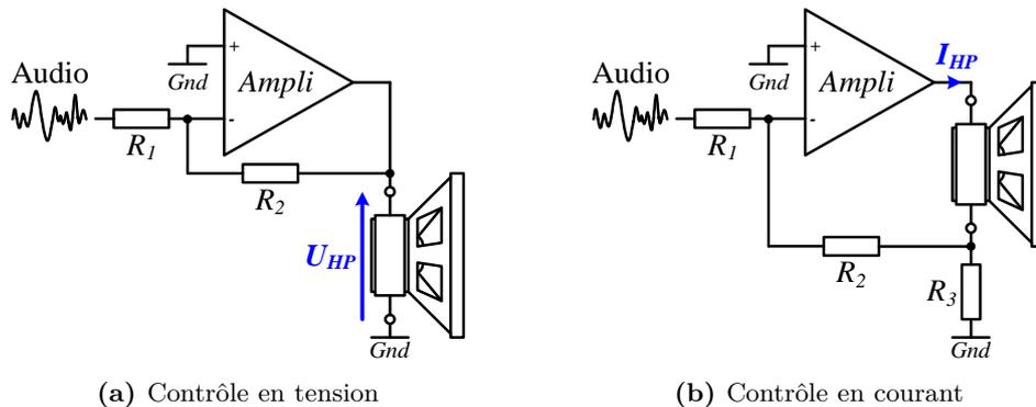
**Figure 3.1** – Principe simplifié du contrôle en tension ou en courant.
