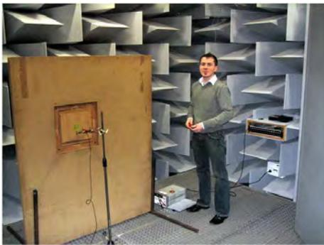
Comme l'illustre la photographie ci-contre, des mesures ont été effectuées en chambre sourde (anéchoïque) pour vérifier le niveau de bruit audible. Il en résulte qu'il est difficile de distinguer des sons pour un bruit  $V_N \leq 0,5 \text{ mV}_{\text{RMS}}$  malgré le très faible niveau environnant ( $L_{P_{min}} \leq 20 \text{ dBA}$ ). Donc il est fort probable que dans un environnement « normal<sup>22</sup> » le plancher audible serait encore plus élevé.
