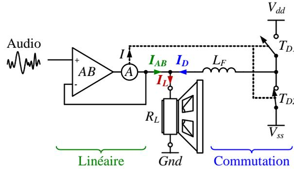
Figure 1.28 – Schéma de principe d'un Classe-K.
