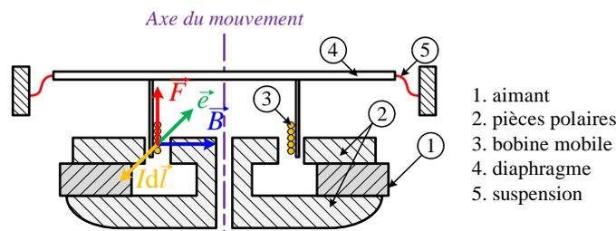
Figure 1.11 – Schéma de conversion électrodynamique à bobine mobile.
