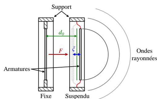
Figure 1.8 – Schéma de principe de la conversion électrostatique.
