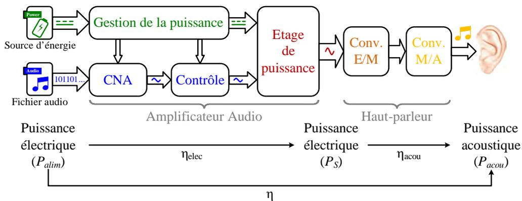
Figure 4.2 – Principe de conversion et répartition du rendement.
