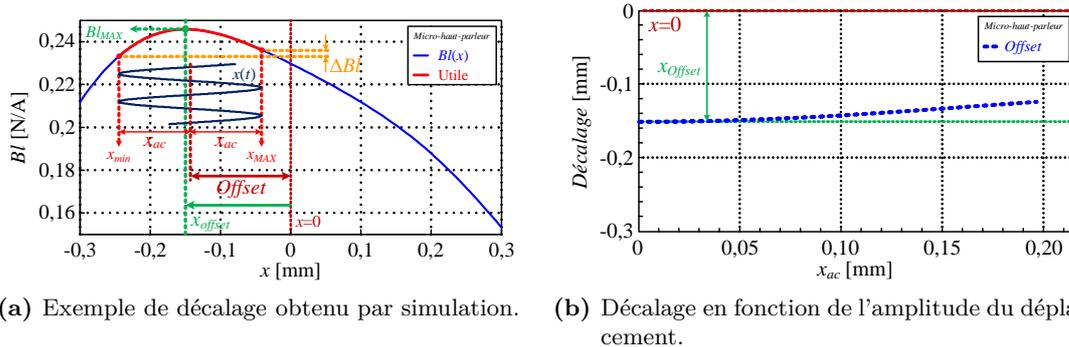
**Figure 2.13** – Différents résultats de simulations de l'offset.
