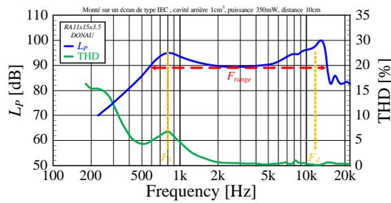
Figure 1.13 – Exemple de réponse en fréquence d'un micro-haut-parleur.
