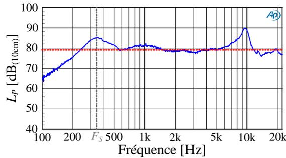
Figure 5.16 – Courbe de réponse en pression acoustique.
