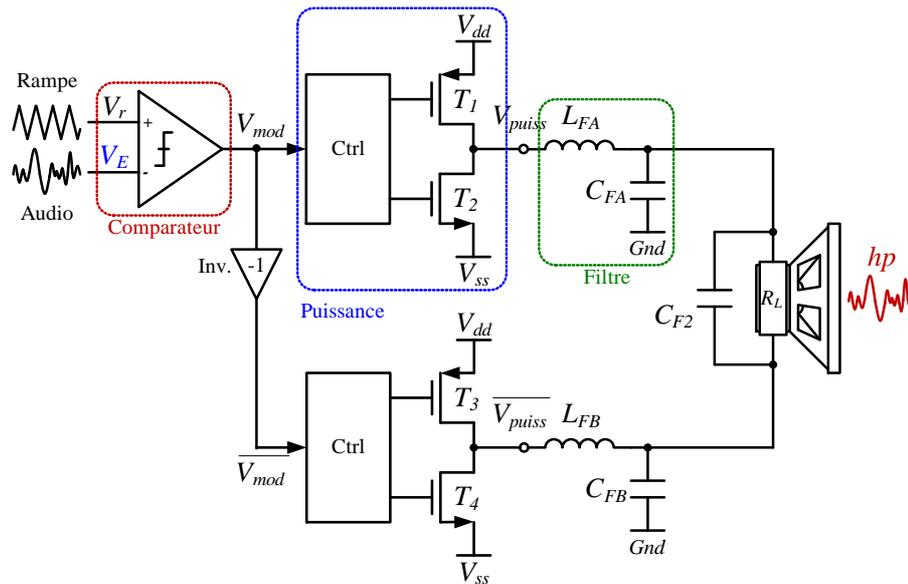
Figure 1.21 – Schéma de principe du Classe-D(bin).
