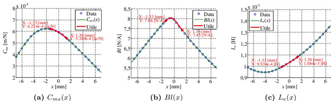
Figure 2.20 – Paramètres non-linéaires en fonction du déplacement.
