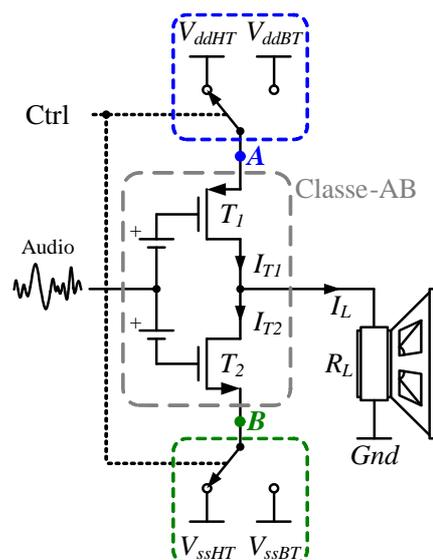
**Figure 1.25** – Schéma de principe du Classe-G (deux niveaux).
