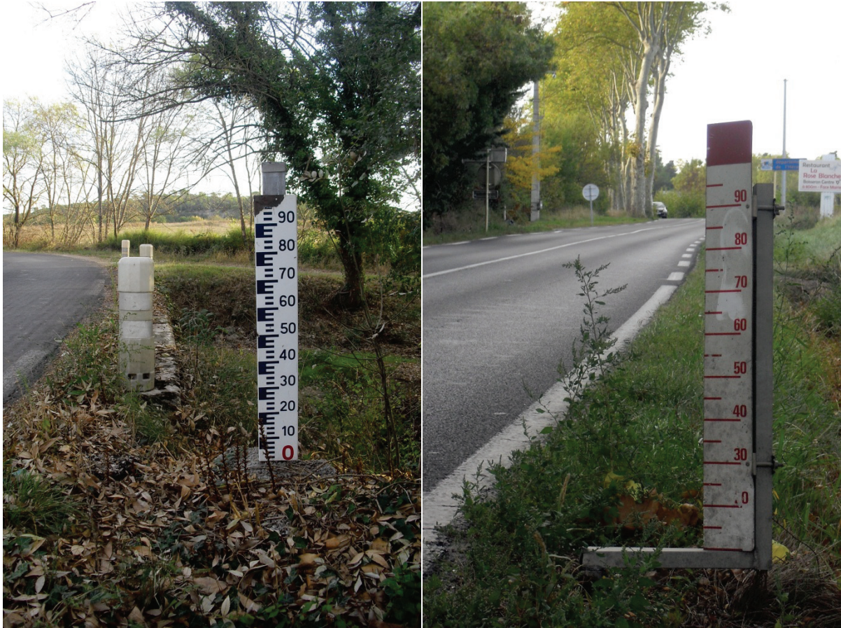
Photo 3 : Exemples de règles graduées en bordure de routes inondables (Laurent Boissier)
