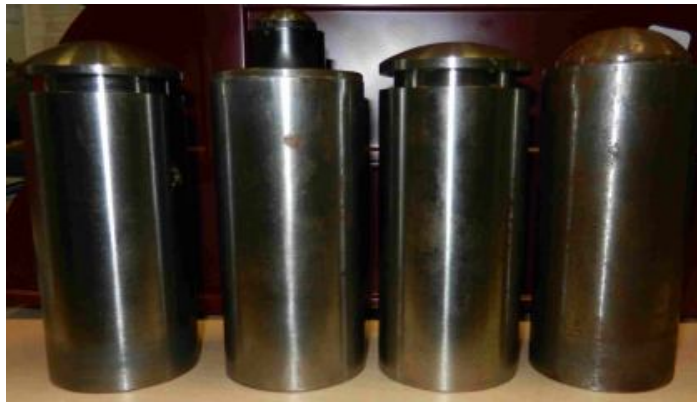
Figure 2.10 : Projectiles à tête sphérique, respectivement de gauche à droite diamètre de 75, 25, 100 et 50mm
