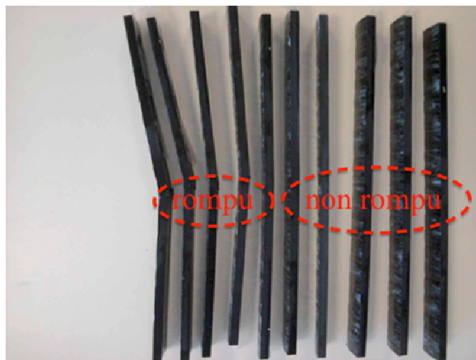
Figure 2.29 : Observation macroscopique des éprouvettes de 5.6mm d'épaisseur
