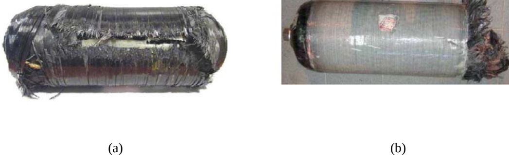
Figure 1.6 : Mode de rupture d'un réservoir (a) sain et (b) non sain (Bertin et al., 2011)
