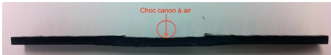
Figure 2.17 : Etat « délaminage multiple » d'une éprouvette de 6.5mm d'épaisseur soumise à un impact de 99J d'énergie
