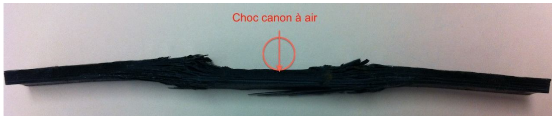
Figure 2.16 : Etat « Morcellement » d'une éprouvette de 6.5mm d'épaisseur soumise à un impact de 284J d'énergie
