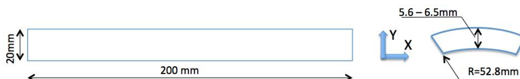
Figure 2-31 : Géométrie de l'éprouvette cylindrique
