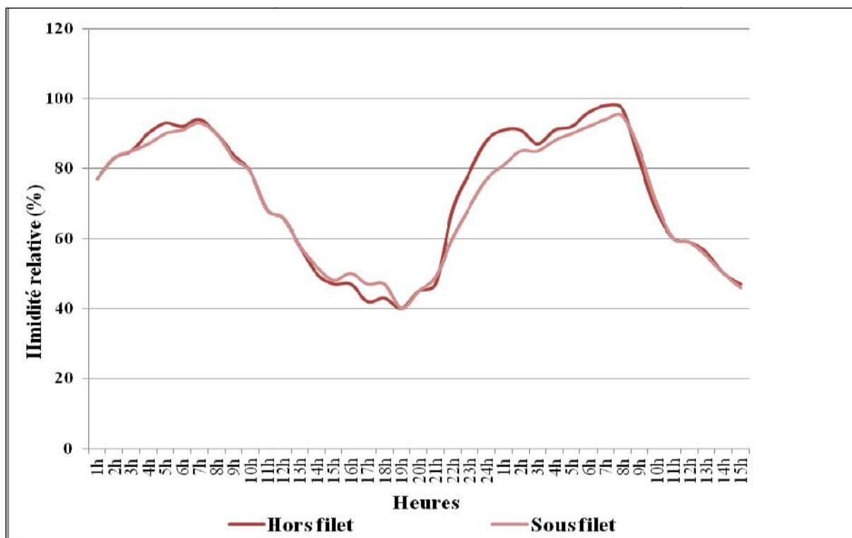
Figure 148. Humidité relative hors et sous filet (cristal autrichien) du 30/07 au 31/07/1996 dans un verger de pommiers à La Mornière dans le Sud de la France (OSAER A. et al., 1996).
