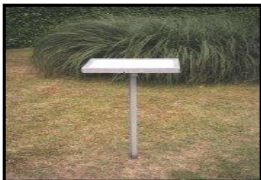
Photo 27. Glélimètre en place (Source : www.anelfa.asso.fr )
