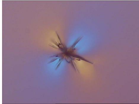
Figure 1-10 Brisure non orientée en volume d'une silice et visualisation des contraintes engendrées.
