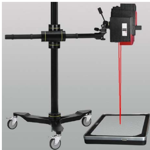
Figure 82 : Calibration du système Gom à l'aide d'un panneau doté de cibles.
