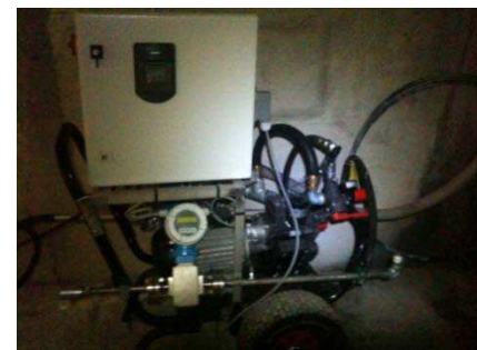
Figure 26 : (a) Schéma conceptuel de la sonde MHP utilisés lors de l'expérience 2. (b) Photographie de la motopompe d'injection située à l'entrée de la galerie.
