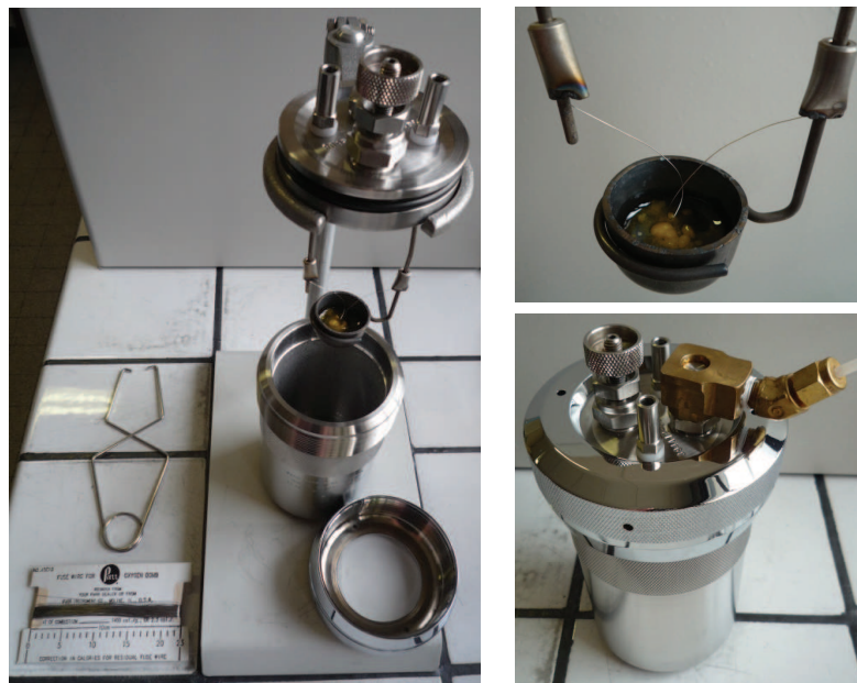
FIGURE 4.1 : De gauche à droite et de haut en bas : poignée amovible et fil fusible à côté de la bombe en préparation, gros plan sur le fusible et le creuset contenant l'échantillon et l'huile, bombe fermée et connecteur d'oxygène en place pour le remplissage.
