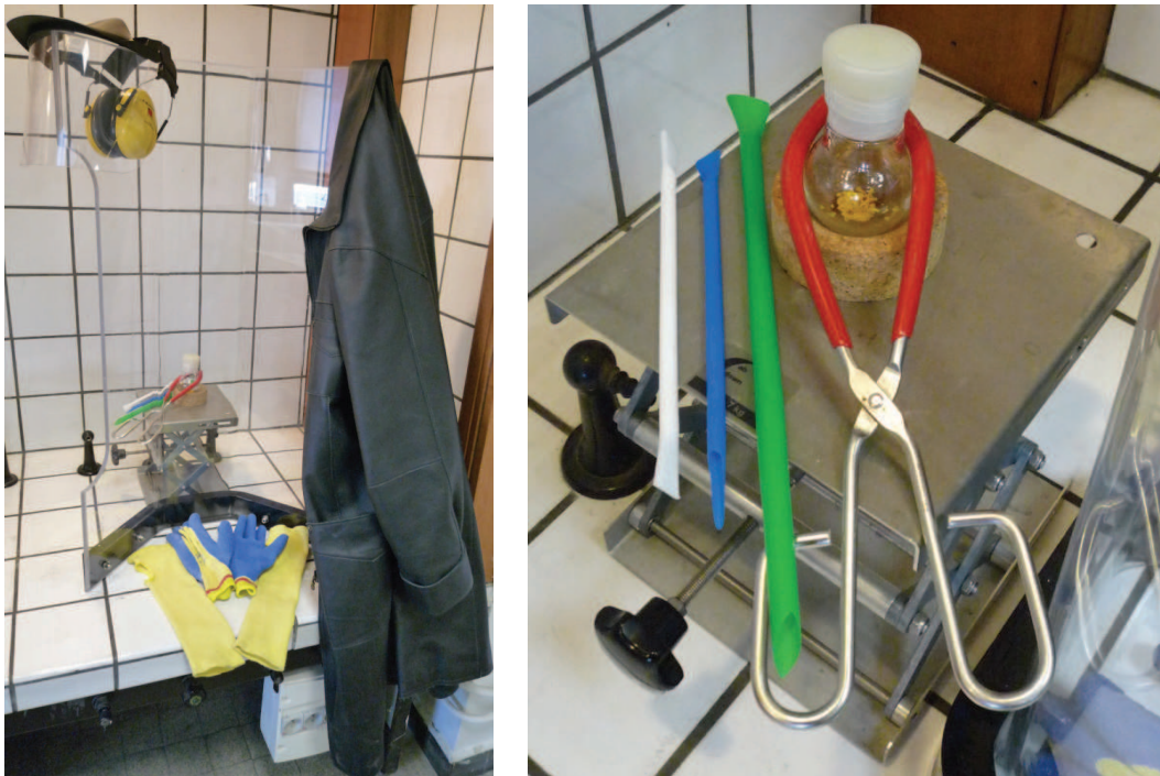
FIGURE 6.4 : Vue d'ensemble des moyens de protection (à gauche) et gros plan sur les ustensiles de préhension (à droite).
