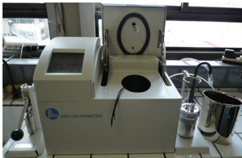
FIGURE 6.2 : De gauche à droite : presse à pastiller, calorimètre ouvert, bombe sur son support de démontage et seau.
