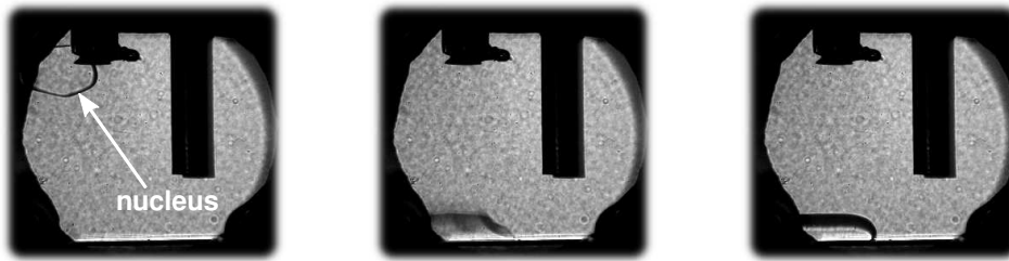
Figure 2.8. Photographies de la cellule montrant les différentes étapes de la nucléation d'un cristal. Le nucléateur est visible en haut à gauche, et la barre noire verticale est une tige en laiton utilisée pour les supports des émetteurs. Le cristal nucléé sur le nucléateur auquel il reste accroché. Lorsqu'il devient trop lourd, il chute sur le plancher de la cellule en se déformant, puis prend ensuite sa forme d'équilibre.
