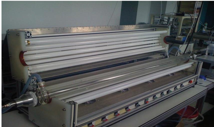
**Figure II. 12 :** Photographie du réacteur à écoulement d'aérosols dans sa boîte d'irradiation ouverte.
