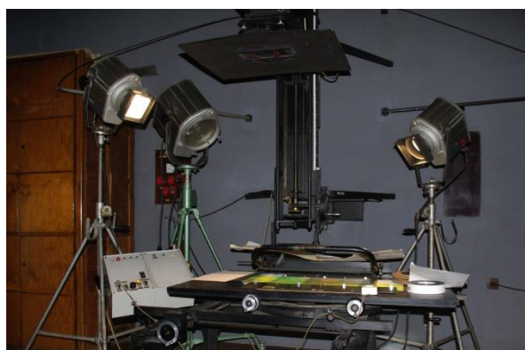
Illustration 16: Appareil banc-titre avec les feuilles en celluloïd (“Cels”) pour la préparation d’un dessin animé dans le studio d’animation Filmów Rysunkowych (Lolek et Bolek) à Bielsko-Biała. Par Janericloebe. Source: Wikimedia: http://bit.ly/18g6Rva .
