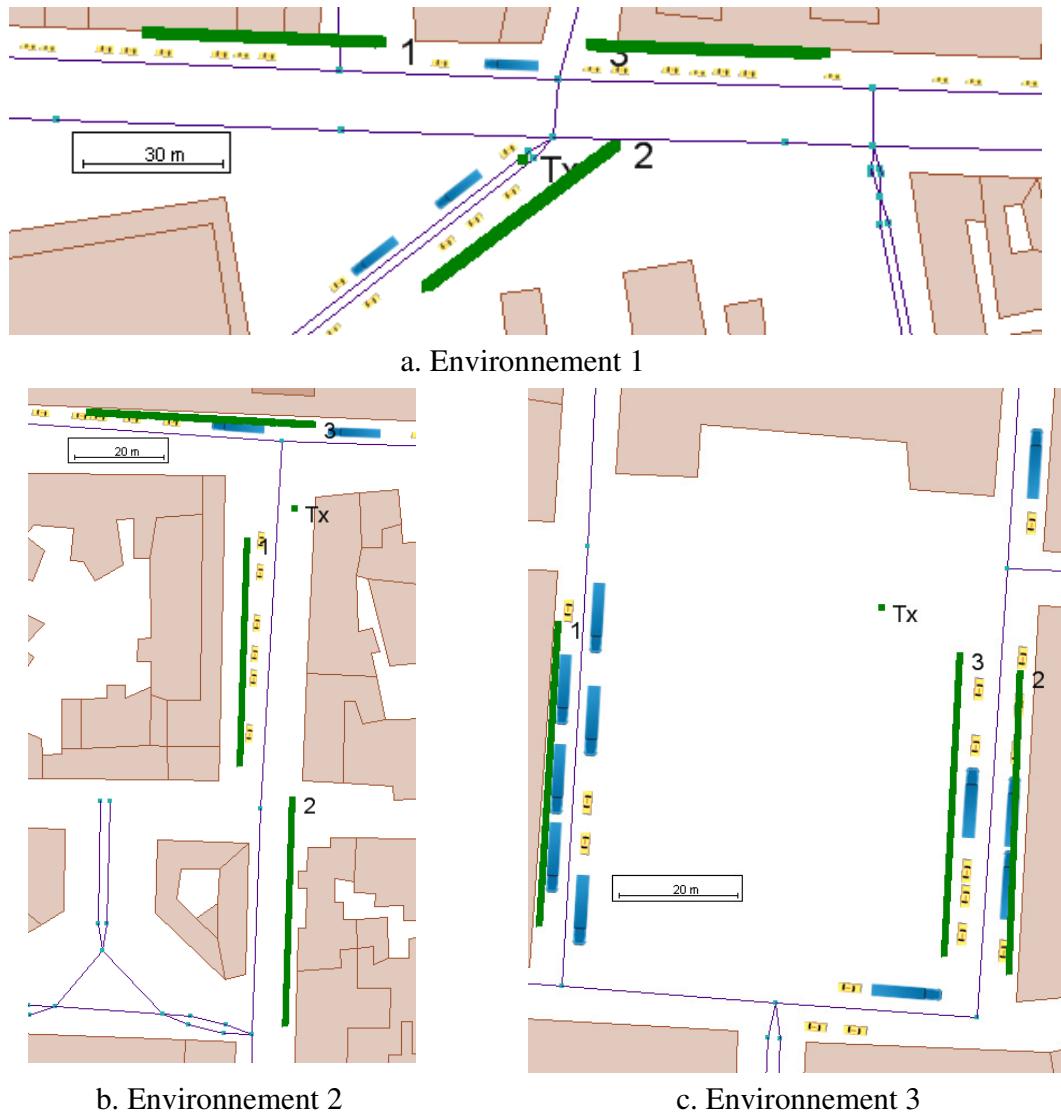
Figure 3.12 : Routes de simulation pour l'étude de l'évanouissement dû au mobilier urbain et illustration de génération de voiture le long des rues
