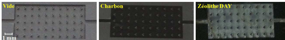
Figure III-14 : Photographie des micro-préconcentrateurs avant et après remplissage
