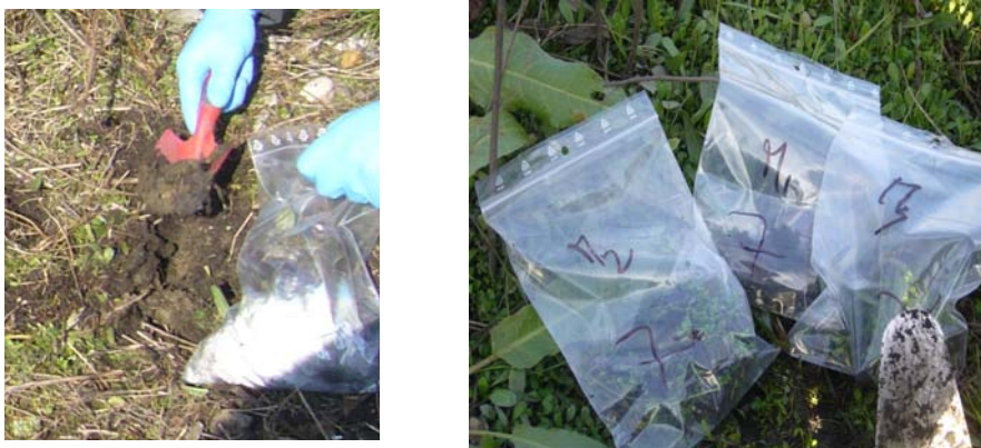
Figure 4-3. Méthode de prélèvement des échantillons in situ . Les échantillons sont prélevés manuellement à l'aide d'une pelle et mis en sac et traité au laboratoire.
