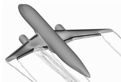
Fig. 1 – Iso-valeurs de la pression autour d'un avion de transport civil complet en hypersustentation (fuselage, nacelles, ailes : becs, volets et spoilers braqués) pour la première fois et pour la prédiction des performances en configuration d'atterrissage. Calcul réalisé en 2011 avec le logiciel « elsA » [21] de l'Onera. Détails : calcul tridimensionnel en régime stationnaire et turbulent, utilisant une approche RANS et une méthode des volumes finis d'ordre deux, ainsi qu'un maillage structuré contenant plus de 33 millions de points. Illustration extraite de [21, figure 3], où les couleurs ont été converties en échelle de gris.
