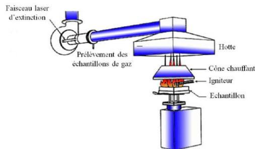
figure II-23 : Schéma d'un cône calorimètre [Laoutid *et al.*, 2009]
