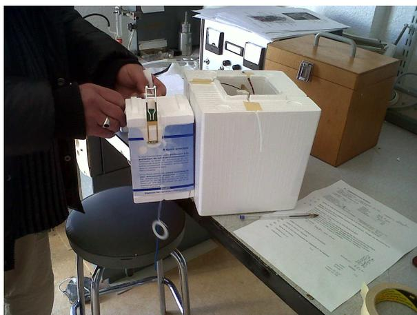
FIGURE 2.6: Nacelle composée de la sonde ozone (boite en polystyrène blanc) et de la sonde météorologique (boite bleue).
