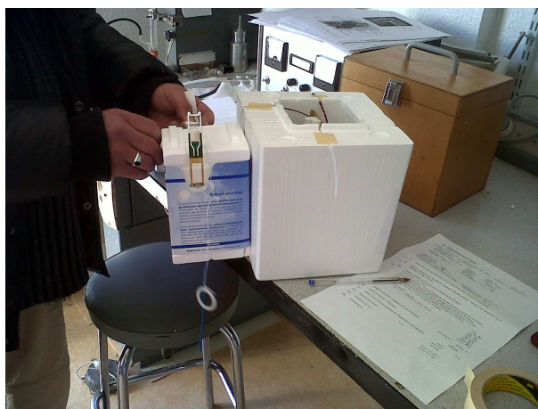
FIGURE 2.6: Nacelle composée de la sonde ozone (boite en polystyrène blanc) et de la sonde météorologique (boite bleue).
