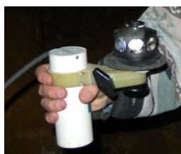
Figure 114 : Capteur du magnétomètre G858, Geometrics. © cliché : A. Burens.
