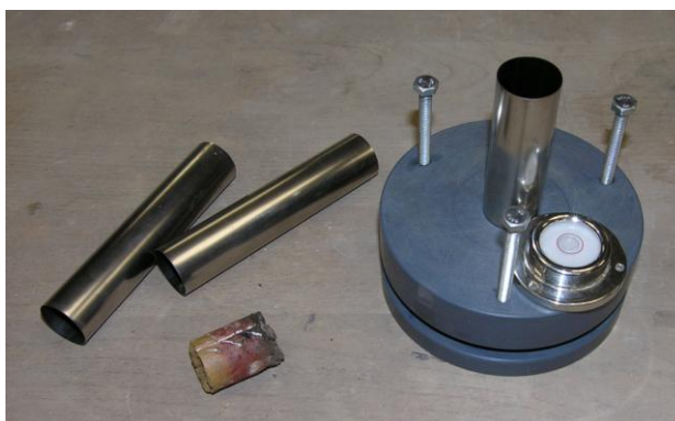
Figure 54 : Matériel de prélèvement des carottes et prélèvement n°16. © cliché : G. Hervé.
