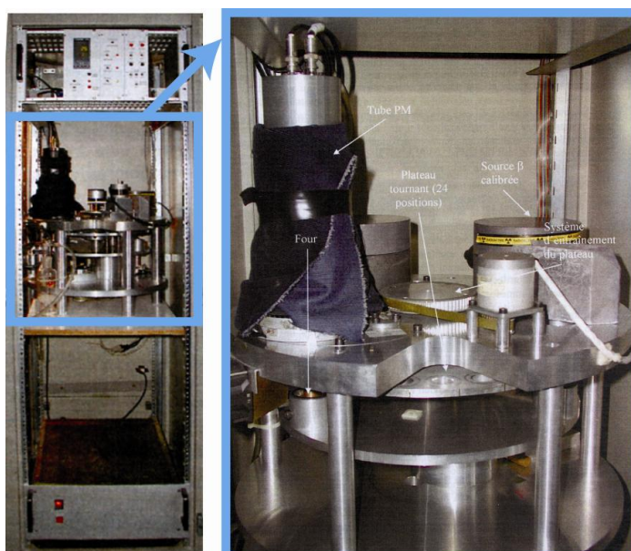
Figure 8 : appareillage de mesure de TL © C. Lahaye.
