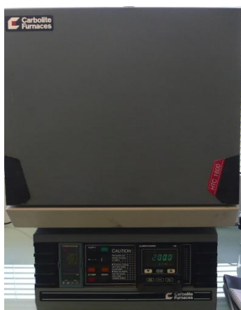
Figure 7 : four à chambre (Eurotherm 2416CG, CARBOLITE).
