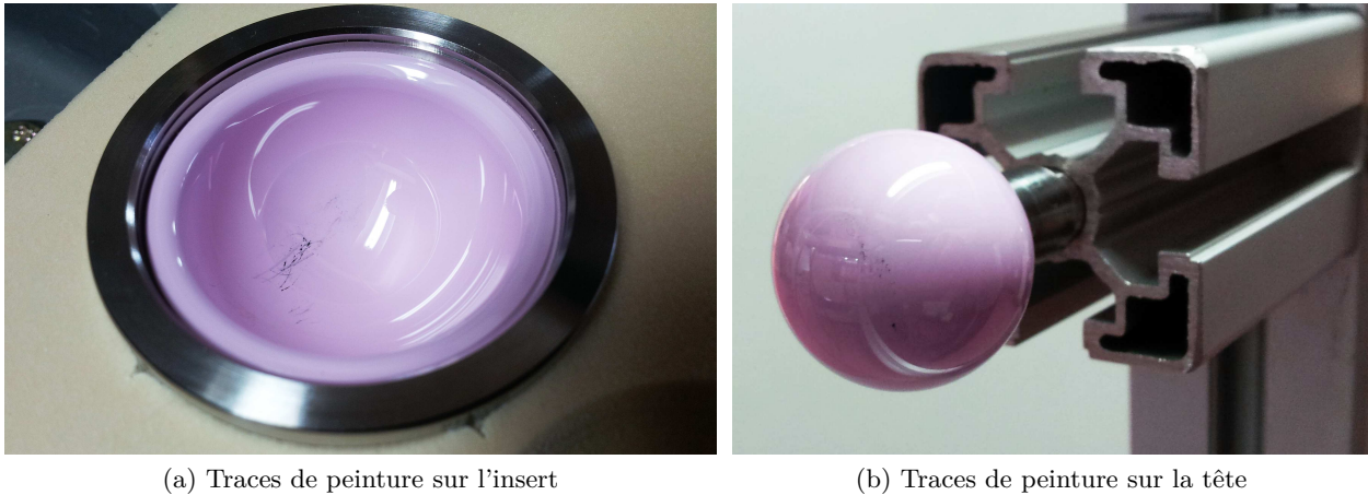
Fig. 5.12 – Traces de peinture à l'interface
