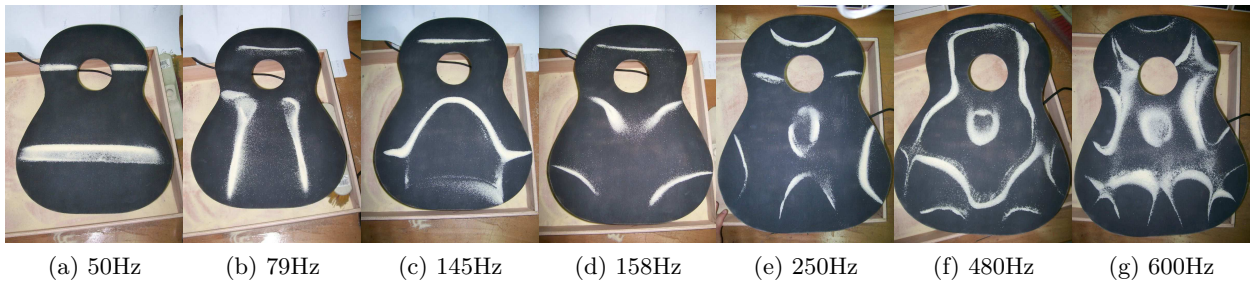
Fig. 1.15 – Modes propres de la table d'harmonie d'une guitare (figures de Chladni) [CHLADNI, 87]
