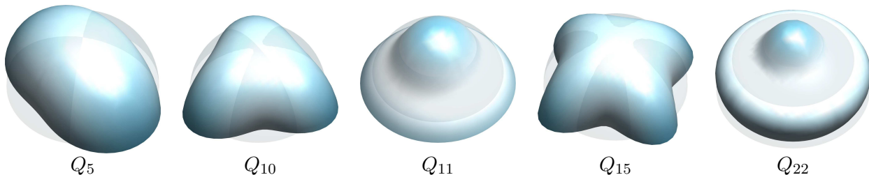
Fig. 4.27 – Les cinq défauts modaux caractéristiques issus des mesures de têtes et d'inserts
