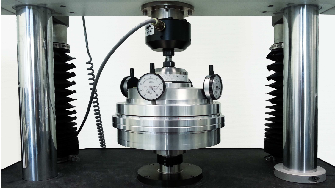
Fig. 3.35 – Assemblage de la bride dans une machine de compression
