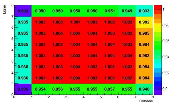
FIGURE 6.10: Fraction d'énergie récupérée dans le détecteur en fonction de la position du faisceau d'électrons (6 GeV) obtenue par simulation Geant4.
