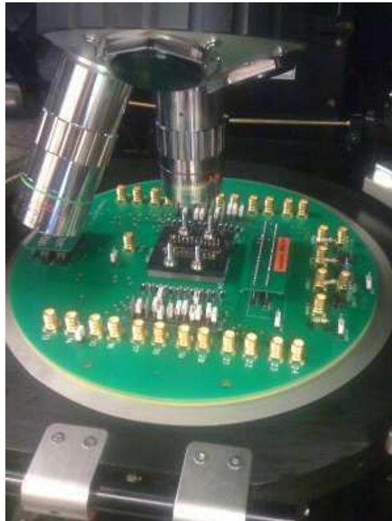
**Figure I. 32. Photographie de la carte de test du circuit cible et de son adaptation sur l'équipement laser.**
