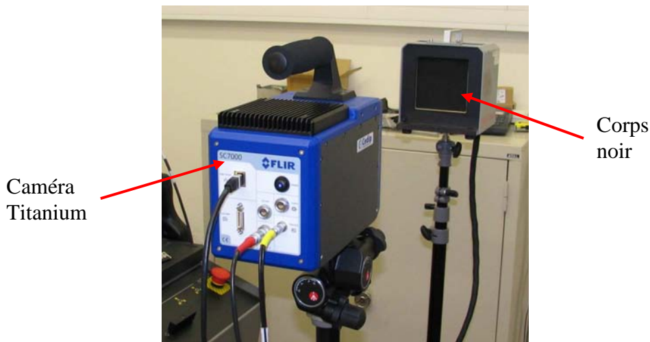
Figure 6.13. Correction de non uniformité à partir du corps noir.
