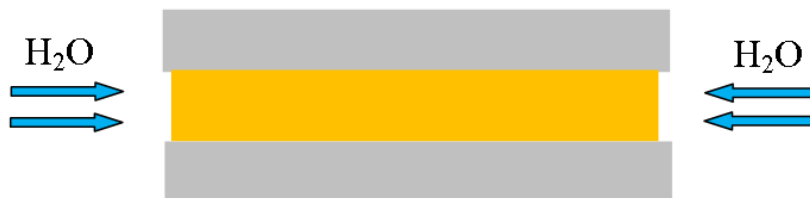
Figure 55 Pénétration d'eau au sein d'un assemblage collé
