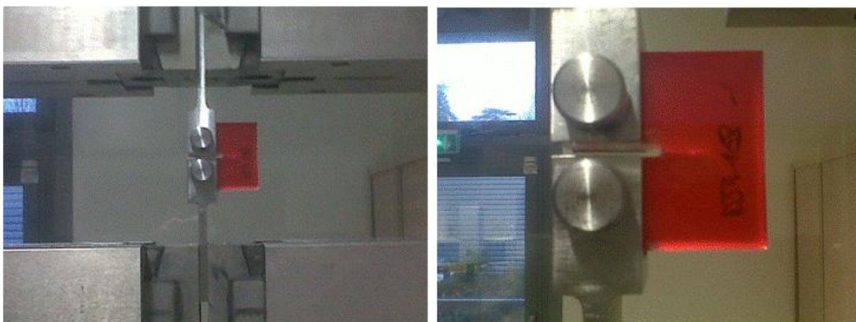
Figure 53 Montage expérimental pour essais de ténacité
