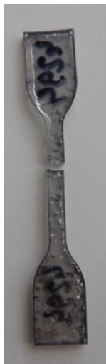
Figure 111 Echantillon de traction de EC294 vieilli 2460h dans l'eau distillée à 50°C
