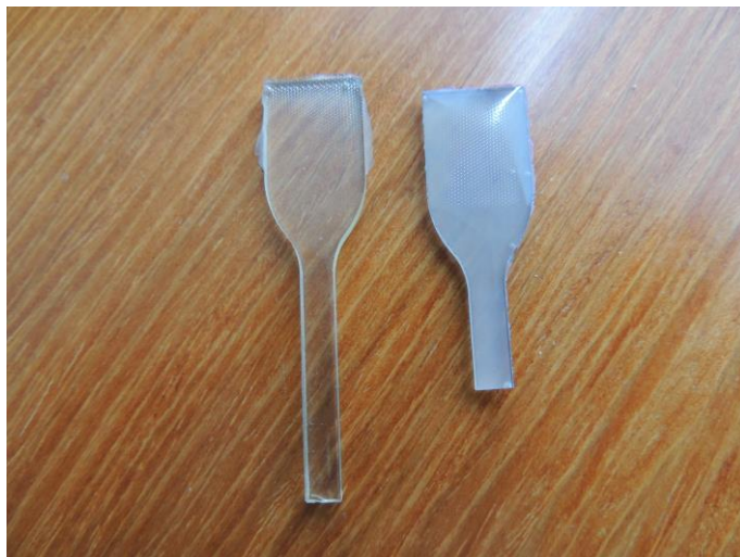
Figure 77 Aspect macroscopique de la formulation EC1104 sur des échantillons de traction avant vieillissement (à gauche) et après saturation en eau (à droite)
