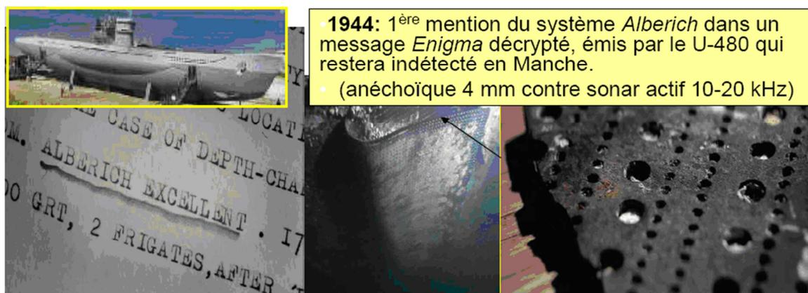
**figure 2-4 : premier matériau anéchoïque contenant des cavités d'air
