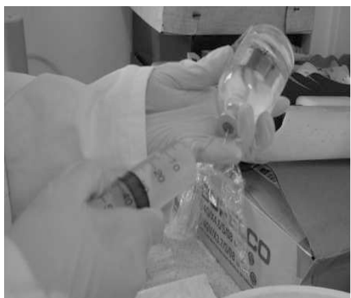
Figure 7 : Injection de l'hélium dans l'échantillon (étape 1)
