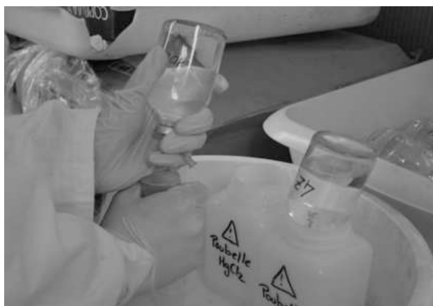
Figure 6 : Injection de l'hélium dans l'échantillon (étape 2)
