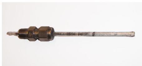
(a) Aiguille de prélèvement d'un échantillon métallique
