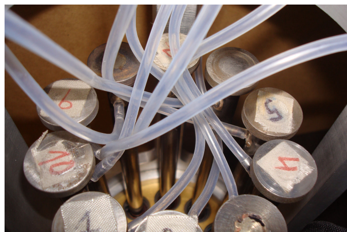
(b) Faisceau de tubes d'aspiration en Rilsan ®
