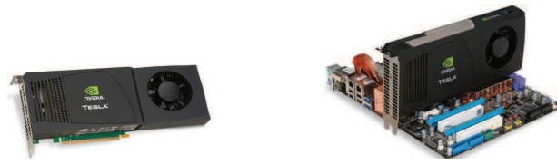
(a) Carte graphique GPU (b) Un GPU relié à un CPU
