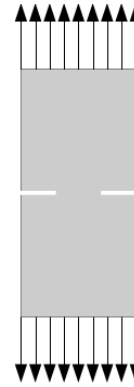
Figure I.11 : Éprouvette entaillée de traction directe.
